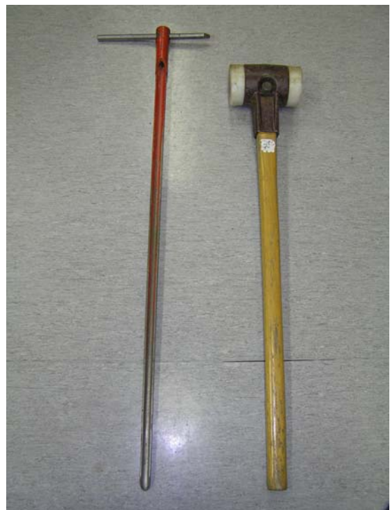
Abb. 2: Bodenbohrer zur Probenahme bis maximal 90 cm Bodentiefe
