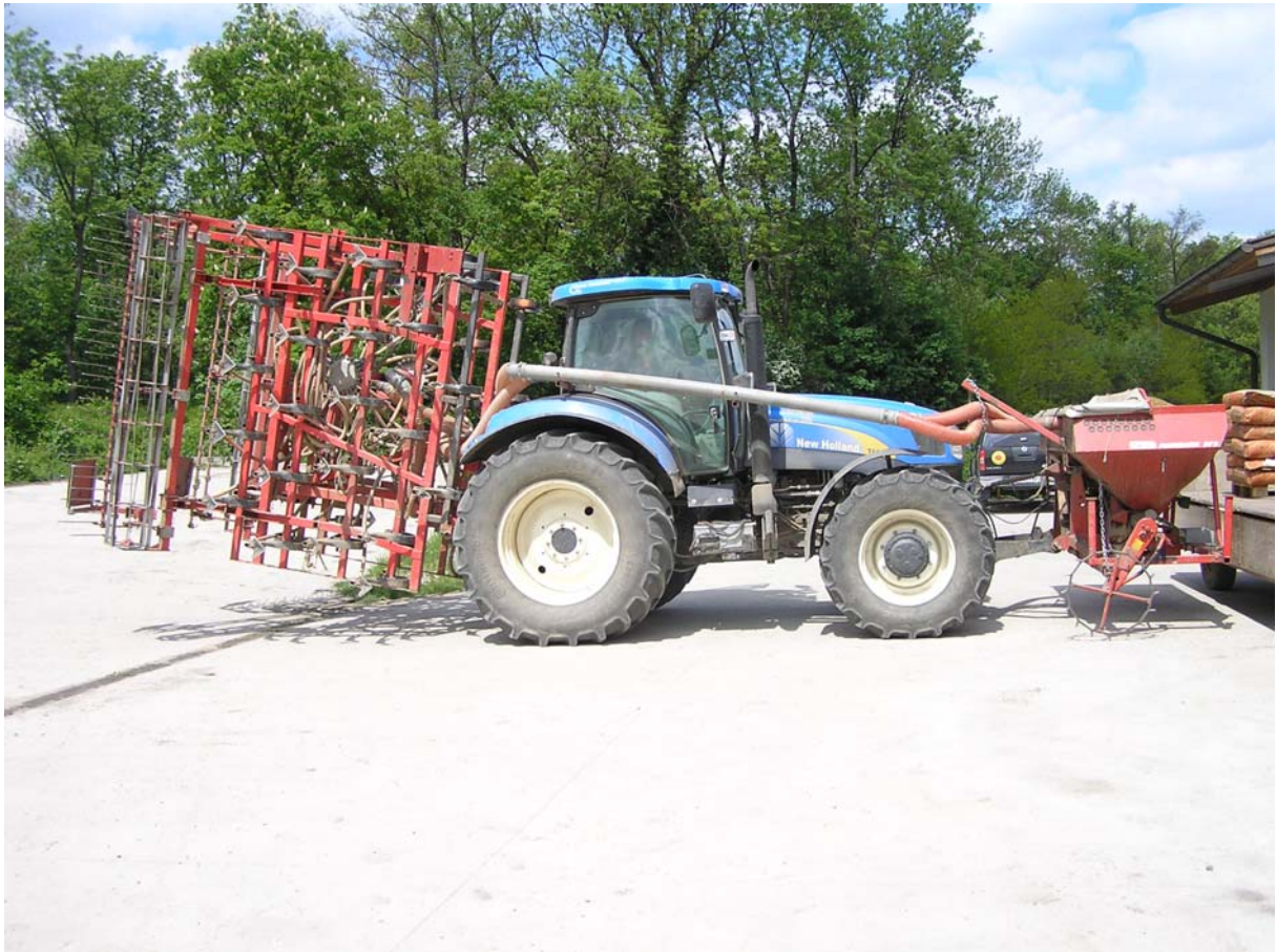
Abb. 1: Zinkensäsystem von Werner Schmitl beim überbetrieblichen Einsatz
