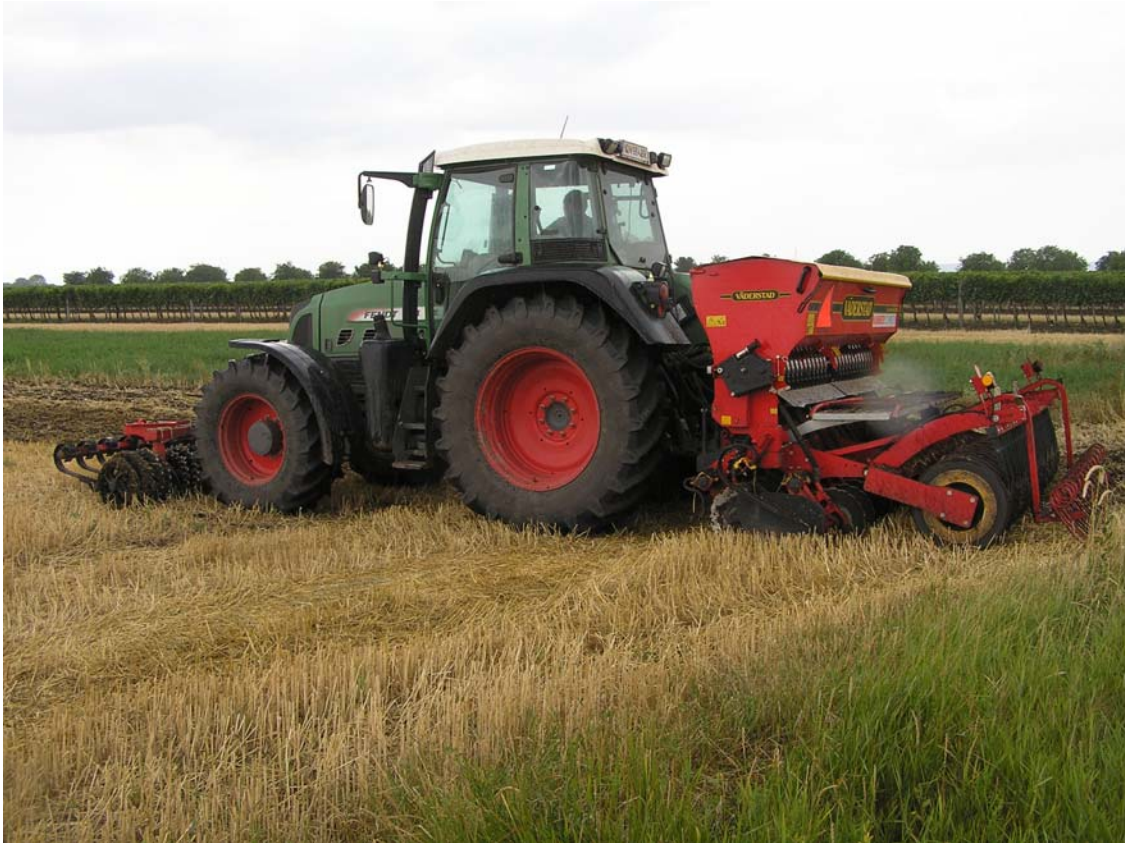
Abb.4: Anbau der Zwischenfrucht direkt in die Stoppel am 19.7.2011 (Kurzscheibeneggen-Sämschienen-Kombination)
