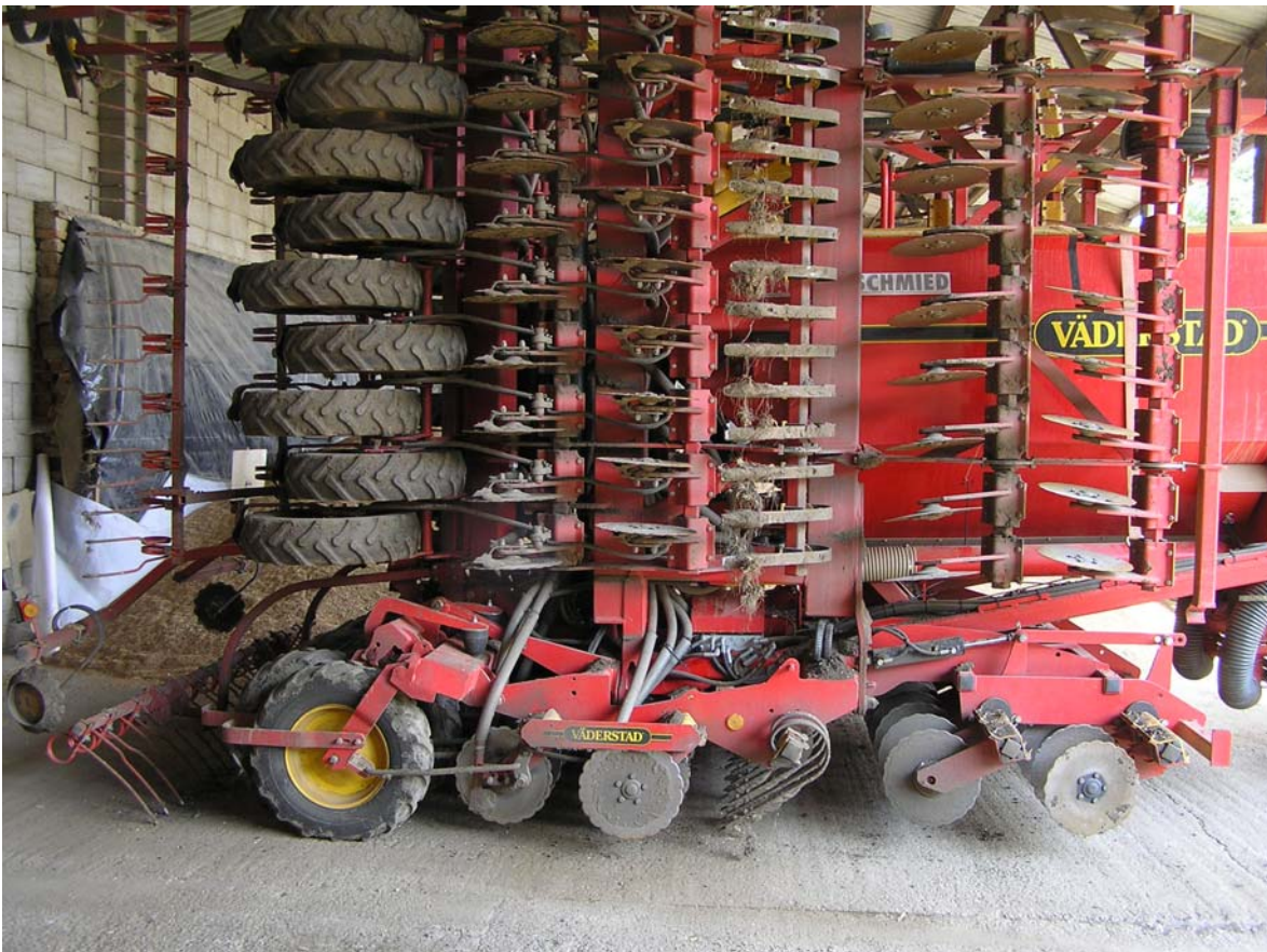
Abb.: Kurzscheibeneggen-Sämaschinenkombination zur Einsaat der Zwischenfruchtmischung am Kleylehof am 28.7.2011
