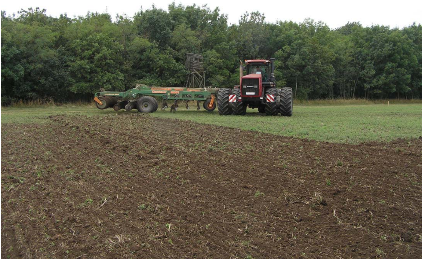
Abb.: Luzerneumbruch mit Grubber (Gänsefußschare, Nachlaufwerkzeuge: Kurzscheibenegge + Packer) am Kleylehof am 28.7.2011
