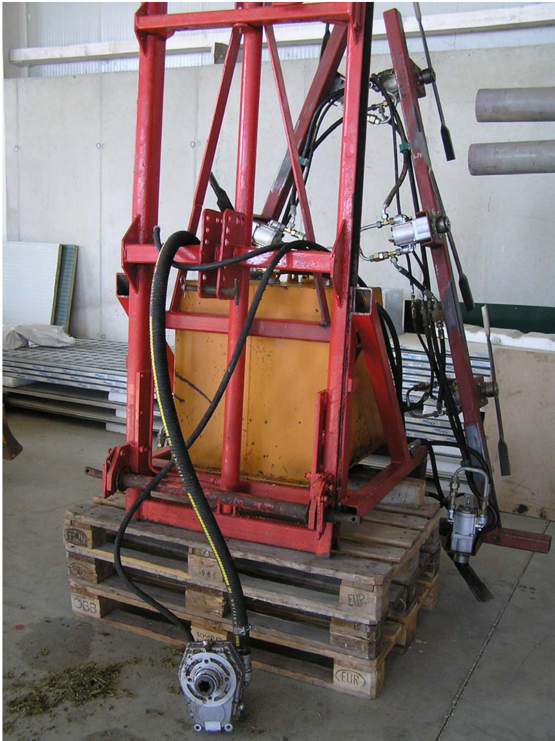
Abb.3: Spätverunkrautungs-Mähgerät mit hydraulischem Antrieb
