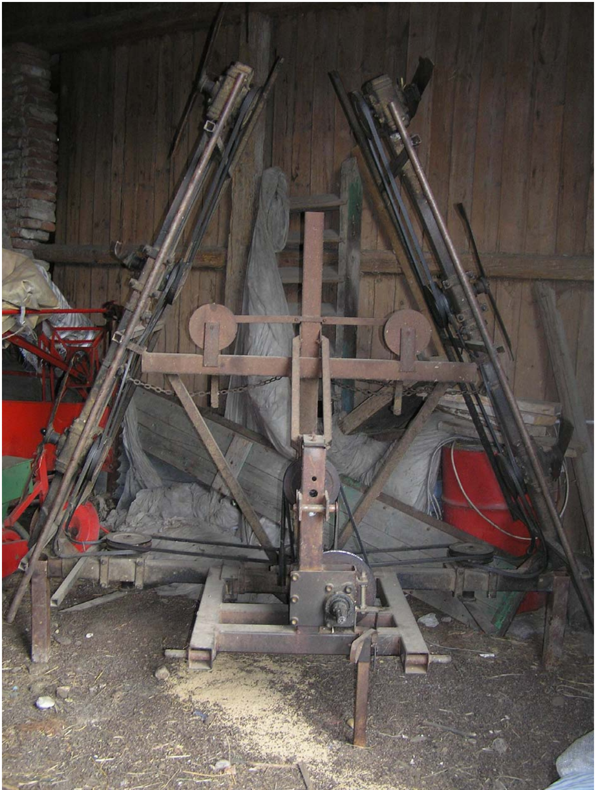
Abb.7: Spätverunkrautungs-Mähgerät mit Keilriemen
