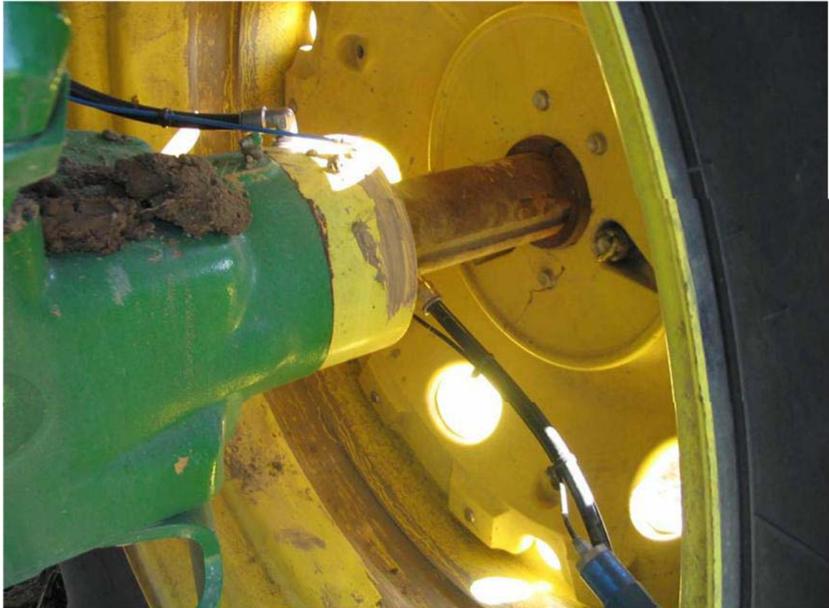
Abb.7: Luftleitung zur Reifendruck-Anpassung während der Fahrt – Innenverlegung; Quelle: www.reifenregler.de
