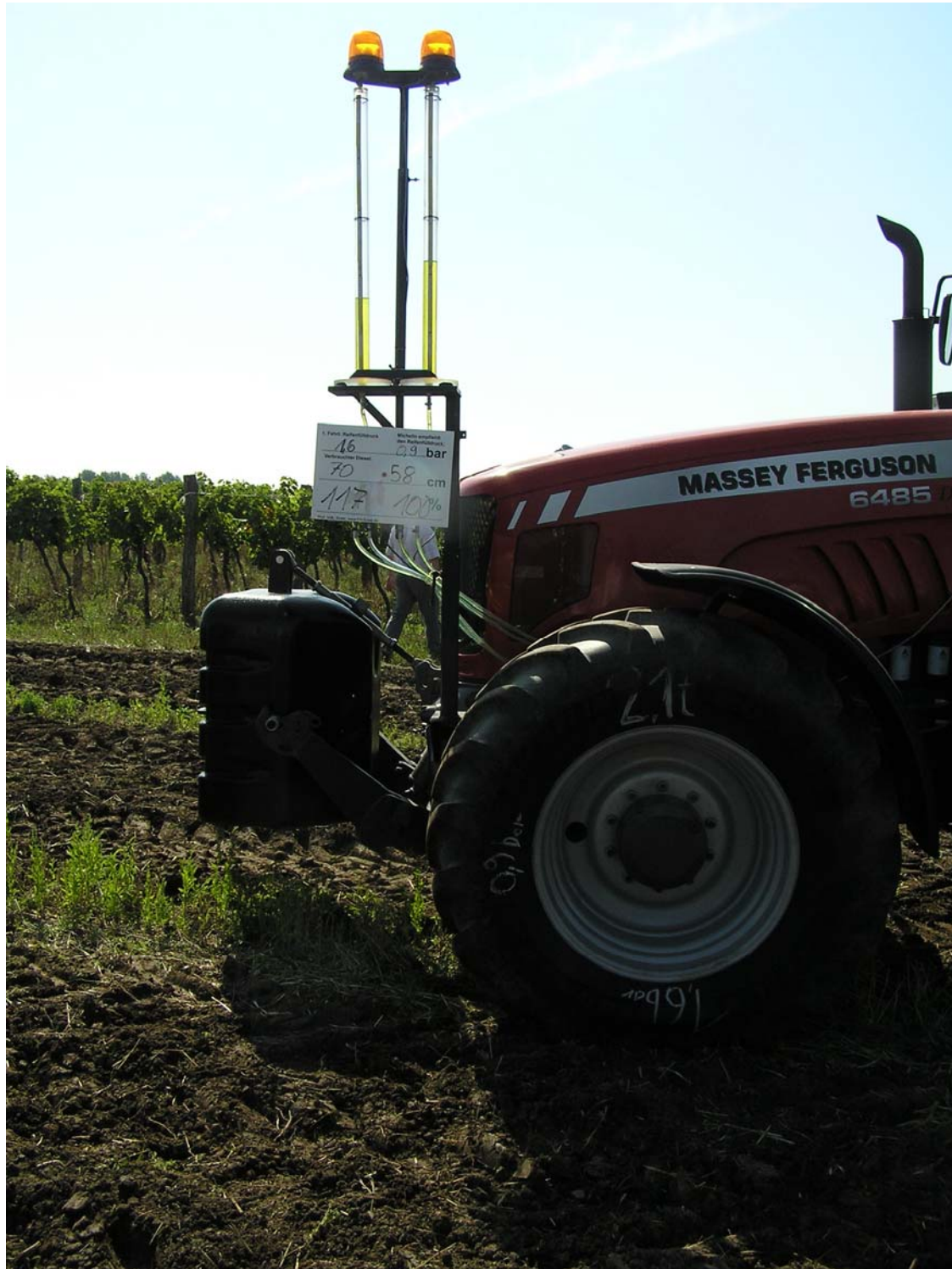
Abb.4: Ergebnis der Verbrauchsmessung bei unterschiedlich eingestelltem Reifeninnendruck
