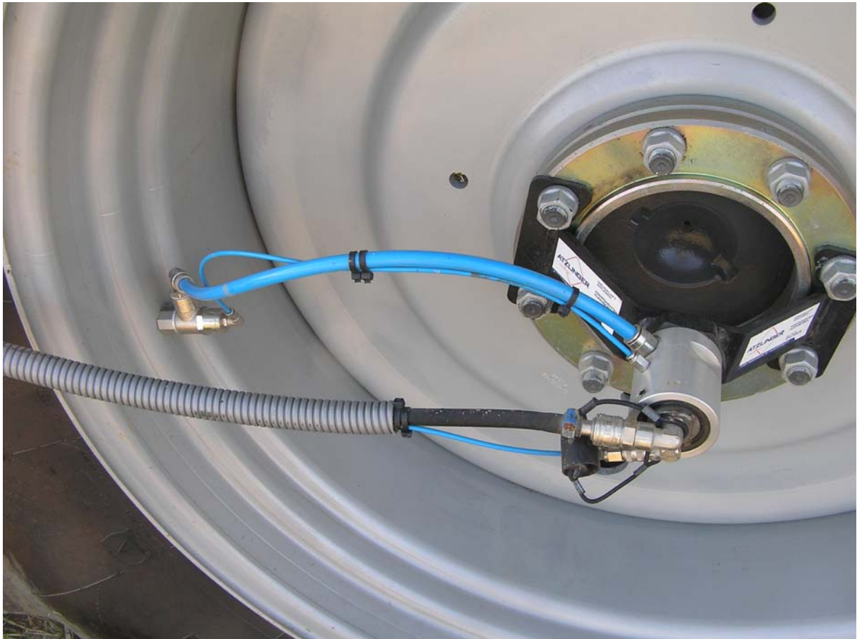
Abb.6: Luftleitung zur Reifendruck-Anpassung während der Fahrt - Außenverlegung
