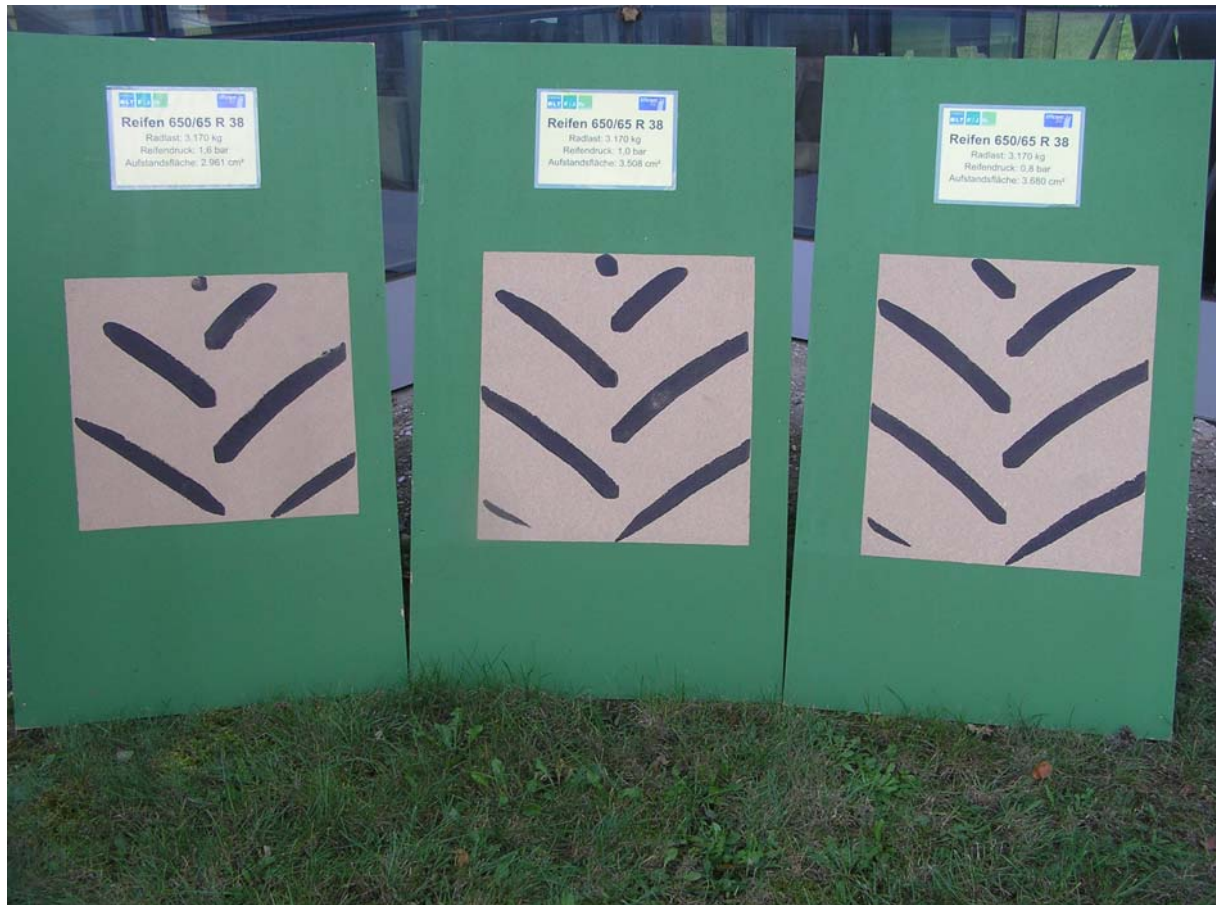
Abb.3: Reifenaufstandsfläche eines Reifens mit 1,6 bar, 1,0 bar und 0,8 bar (von links nach rechts)
