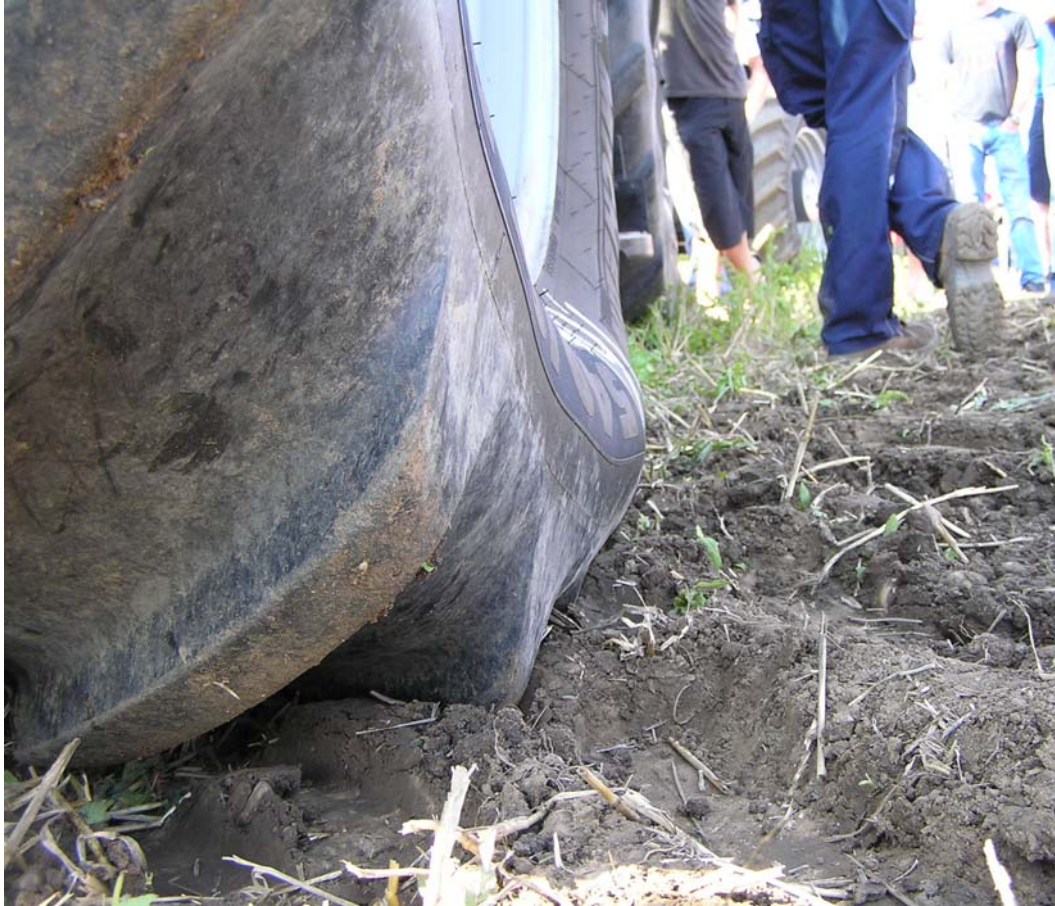
Abb.2: Reifenabplattung durch Absenkung des Innendrucks – bessere Zugkraftübertragung
