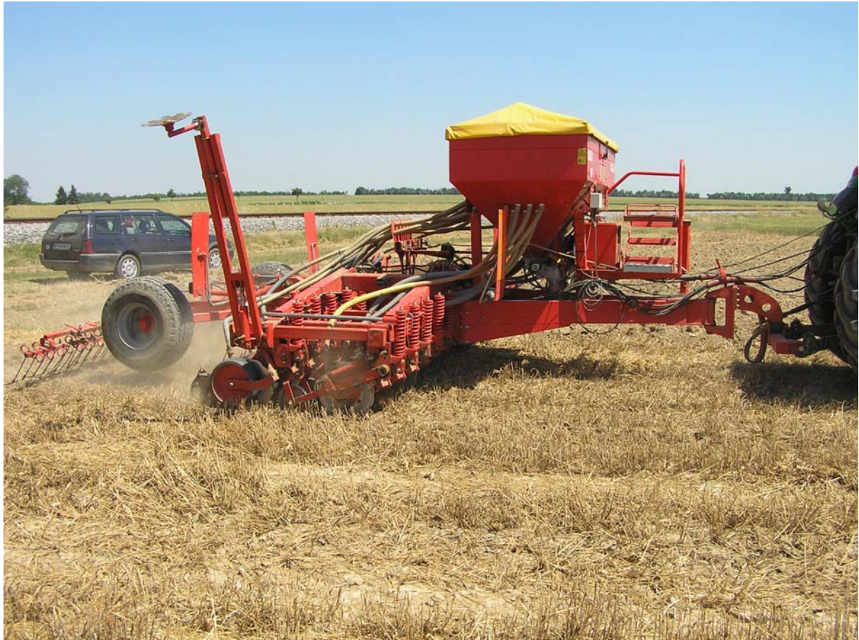
Abb.6: No Till/ Direktsaat direkt in die Stoppel, Aufnahme vom 18.6. 2012
