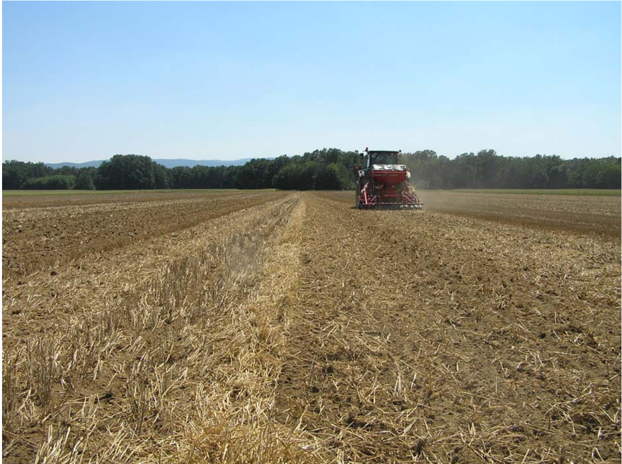
Abb.11: Mulchsaat mit Vorwerkzeug Kreiselgrubber – links mit verminderter Zapfwellendrehzahl (ca. 500 U/min), rechts mit vorgeschriebener Zapfwellendrehzahl (1000 U/min)
