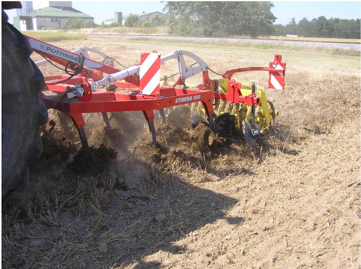
Abb. 12: Stoppelsturz mit Flügelschargrubber
