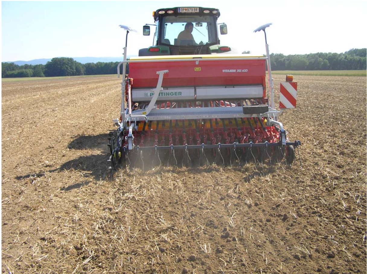
Abb. 14: Arbeitsbild der Kreiselegge und Scheibenschar-Sämaschine
