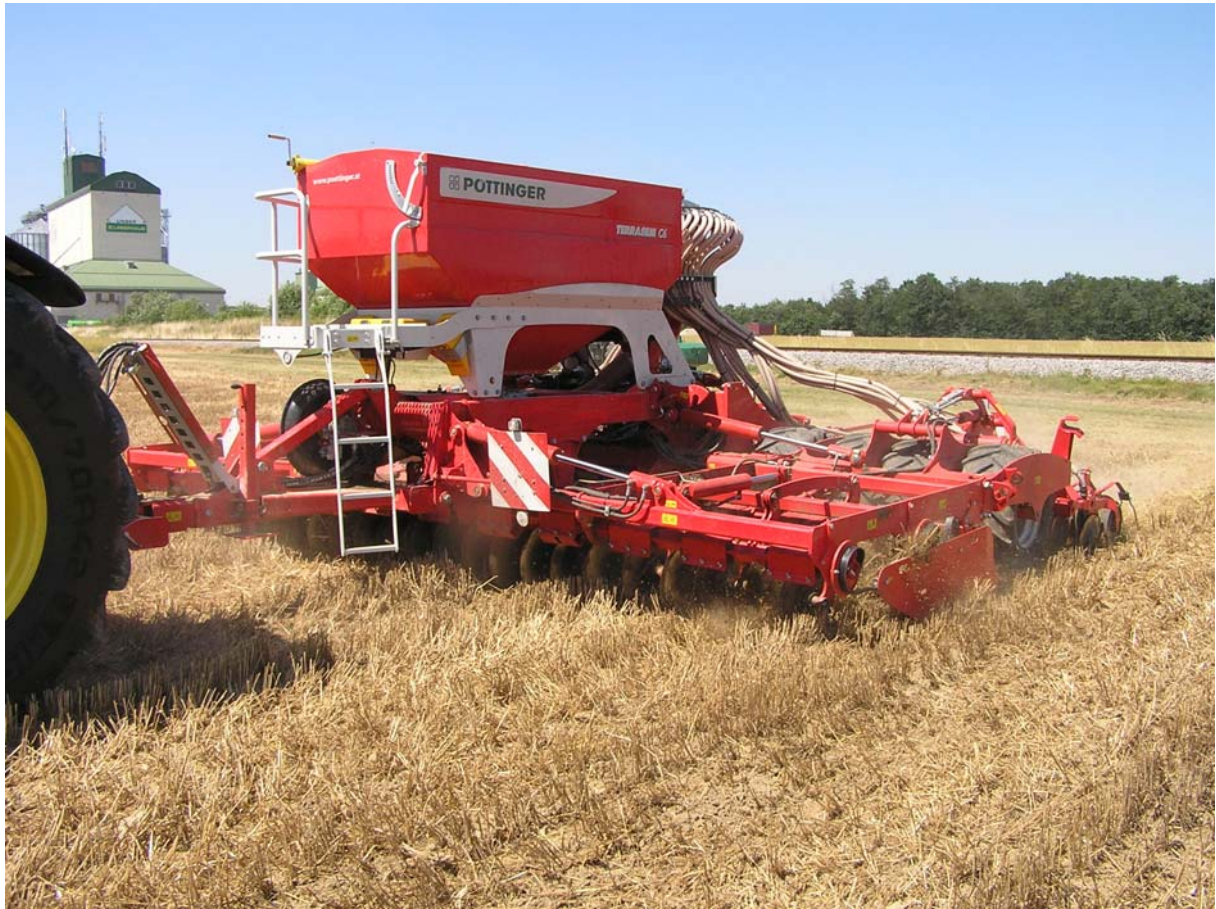
Abb.8: Mulchsaat mit Vorwerkzeug Scheibenegge
