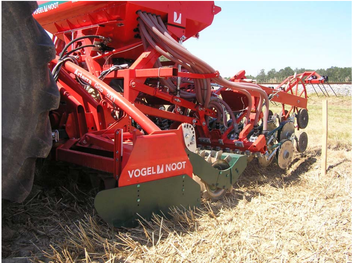
Abb. 10: Mulchsaat mit Vorwerkzeug Kreiselgrubber
