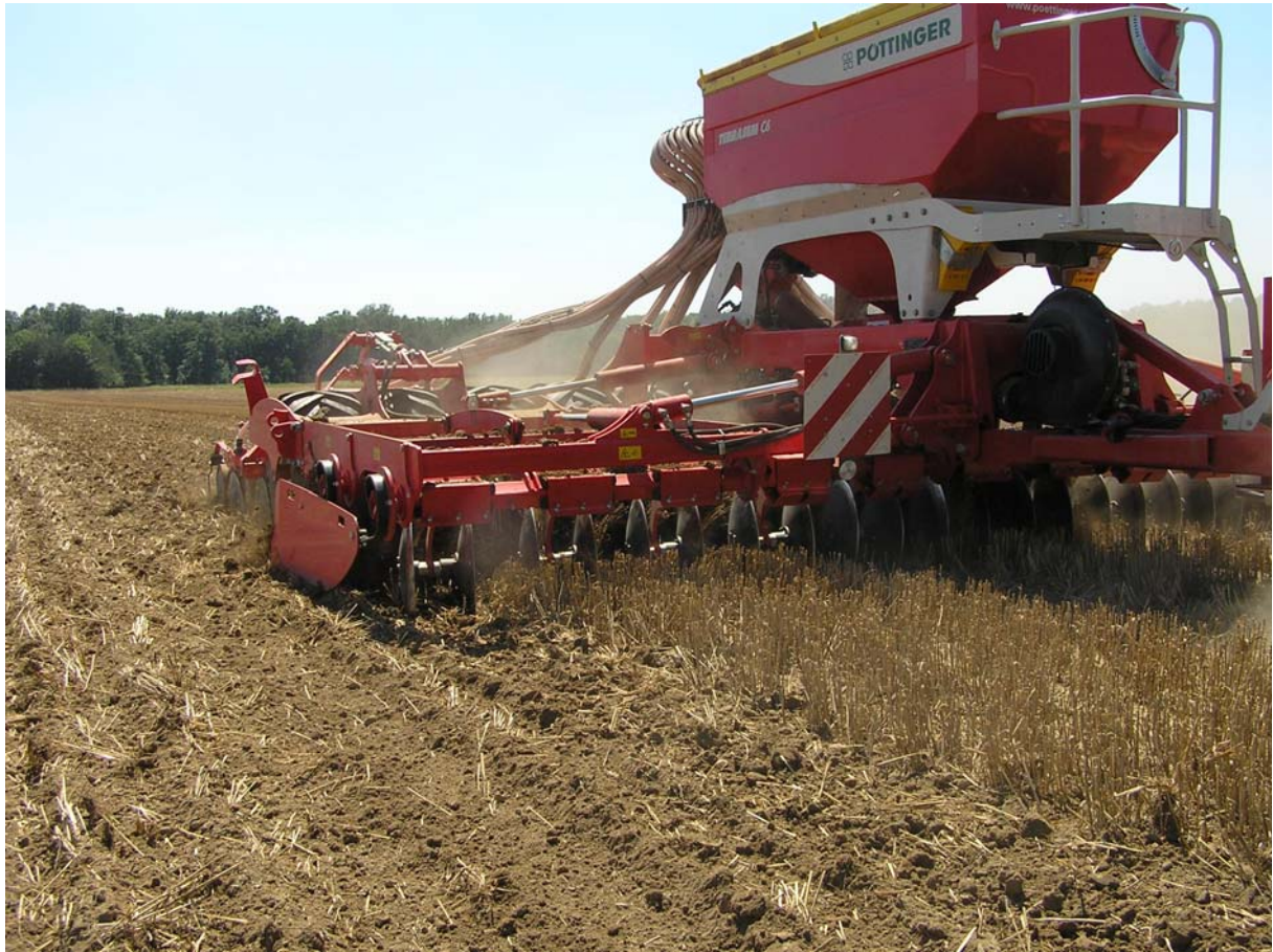
Abb.9: Mulchsaat mit Vorwerkzeug Scheibenegge – tiefere Bearbeitung bei der Rückfahrt
