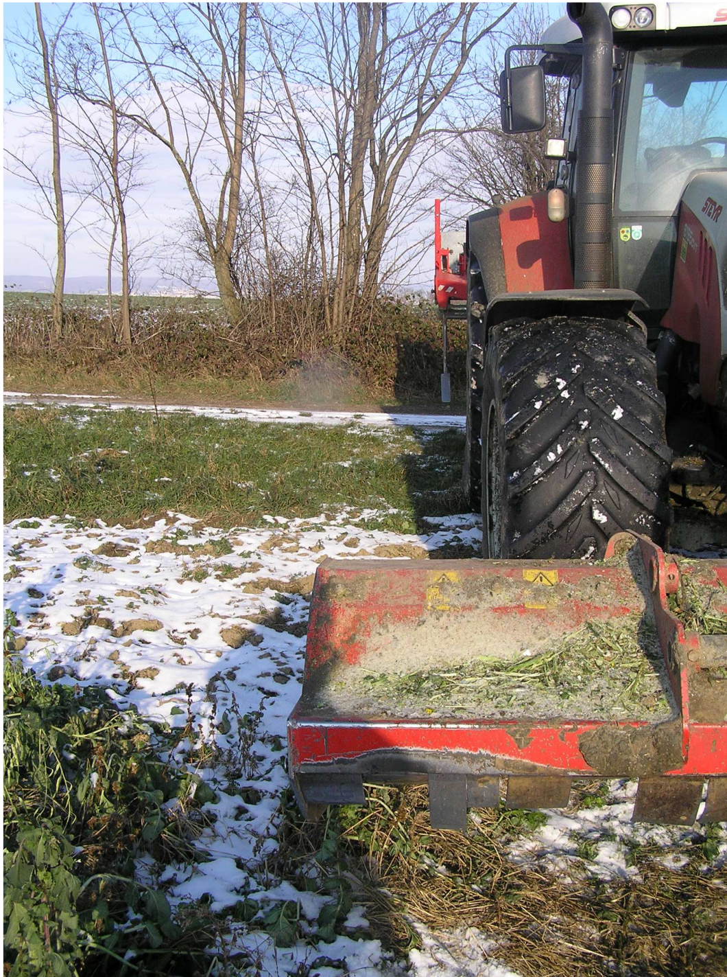
Abb.2: nach rechts (in Fahrrichtung) verschobener Häcksler verhindert den Einwurf von Erdmaterial durch den Grubber in den stehenden Zwischenfruchtbestand Aufnahme vom 12.12.2012
