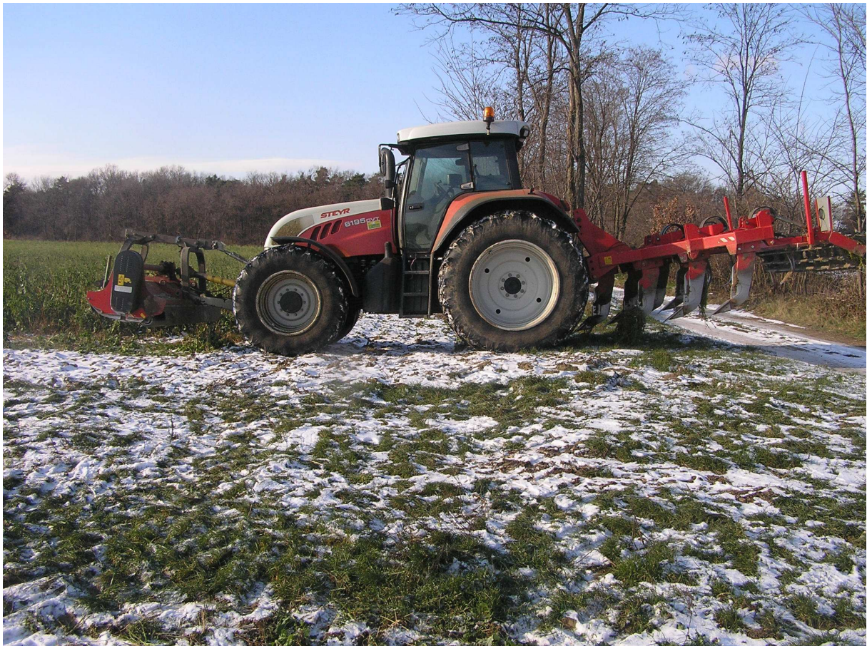
Abb.1: Häcksler im Frontanbau, Grubber im Heckanbau Aufnahme vom 12.12.2012
