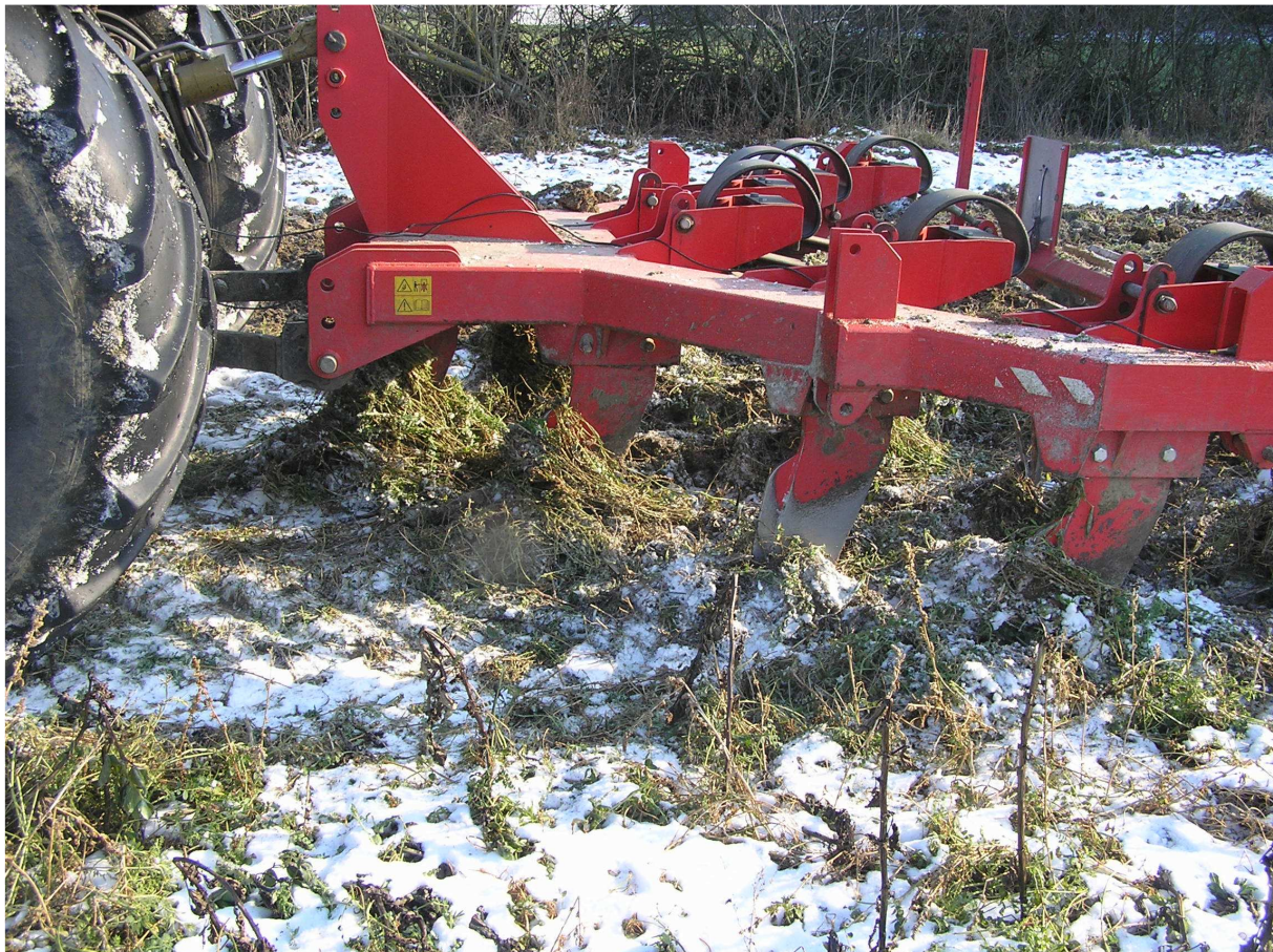
Abb.4: Der Grubber mit weitem Strichabstand wird durch eine zeitweilige Haufenbildung nicht verstopft.
