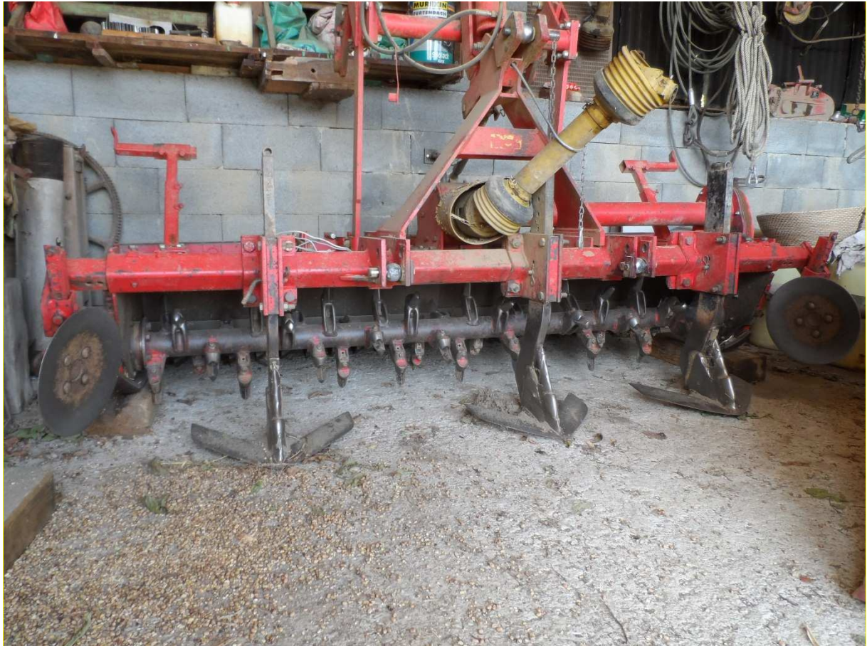
Abb.1: Rotortiller mit Lockerungsscharen und Dreipunkt-Anbaubock für einen kombinierten Einsatz mit der Sämaschine
