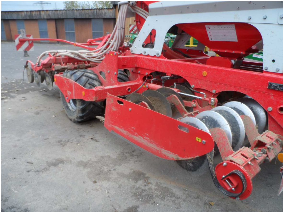
Abb.1: Mulchsaatmaschine mit Kurzscheibenegge-Vorwerkzeug und Doppelscheibenschar
