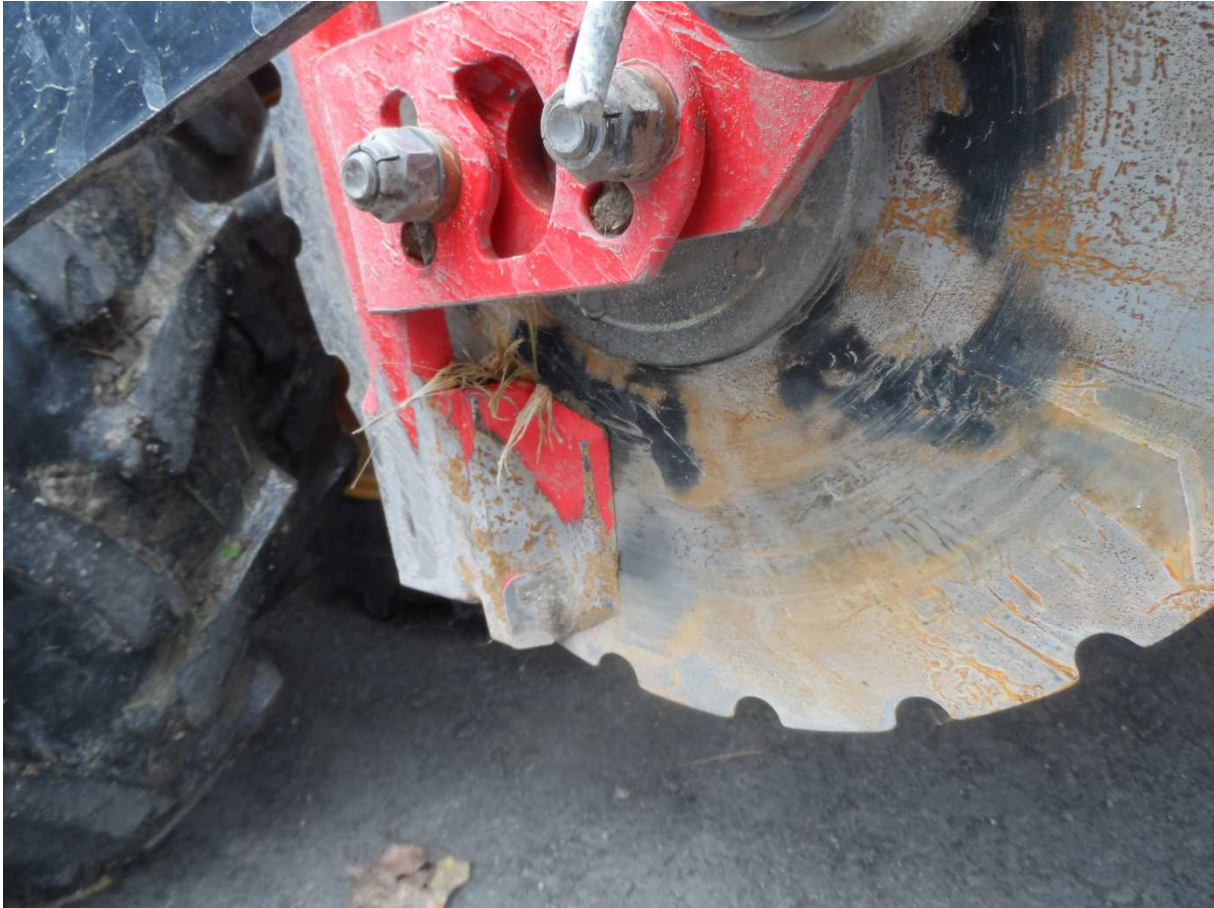
Abb.2: Einscheibenschar einer Mulch- und Direktsämaschine
