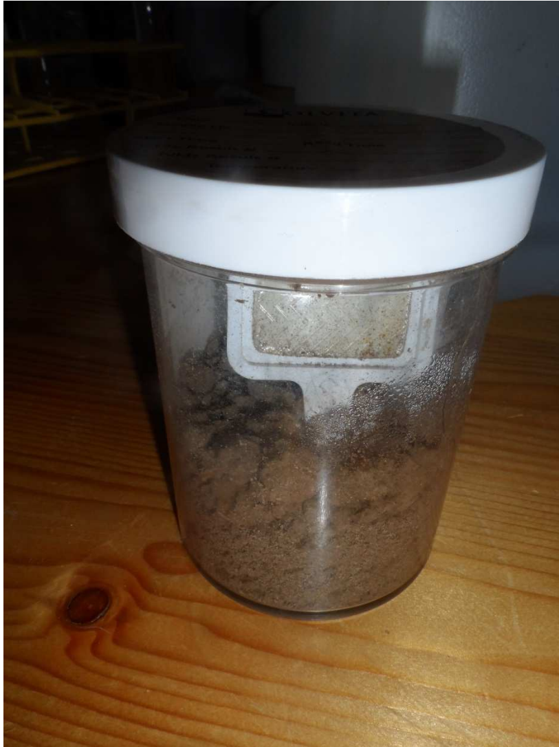
Abb.3: Verschlussener Testbehälter mit Gel-Kärtchen zur Messung der Atemaktivität des Bodenlebens
