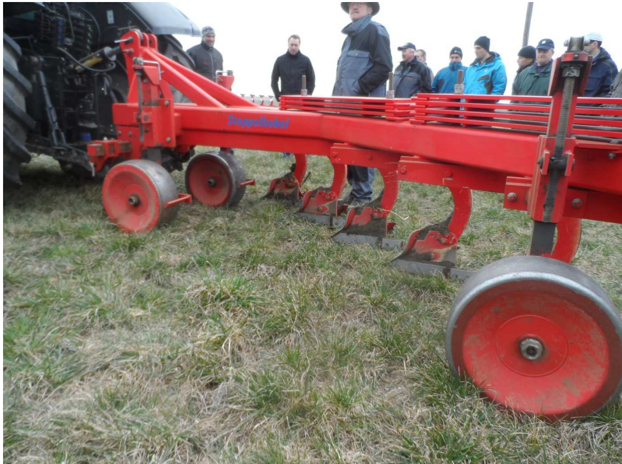
Abb.6: Zobel Stoppelhobel mit drei Stützrädern und Beschwerungsplatten, Oberlenker im Langloch
