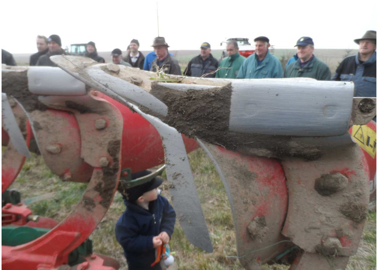
Abb.3: Kverneland Ecomat TM mit gebrauchten Scharen und Winkelmesser
