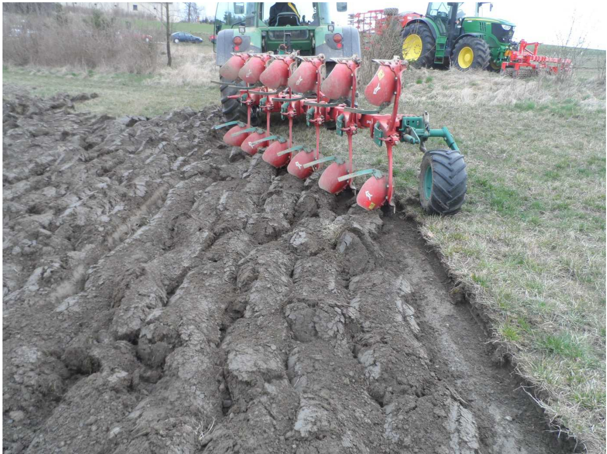
Abb.2: Kverneland Ecomat TM mit Einlegeblechen und Stützrad am letzten Schar
