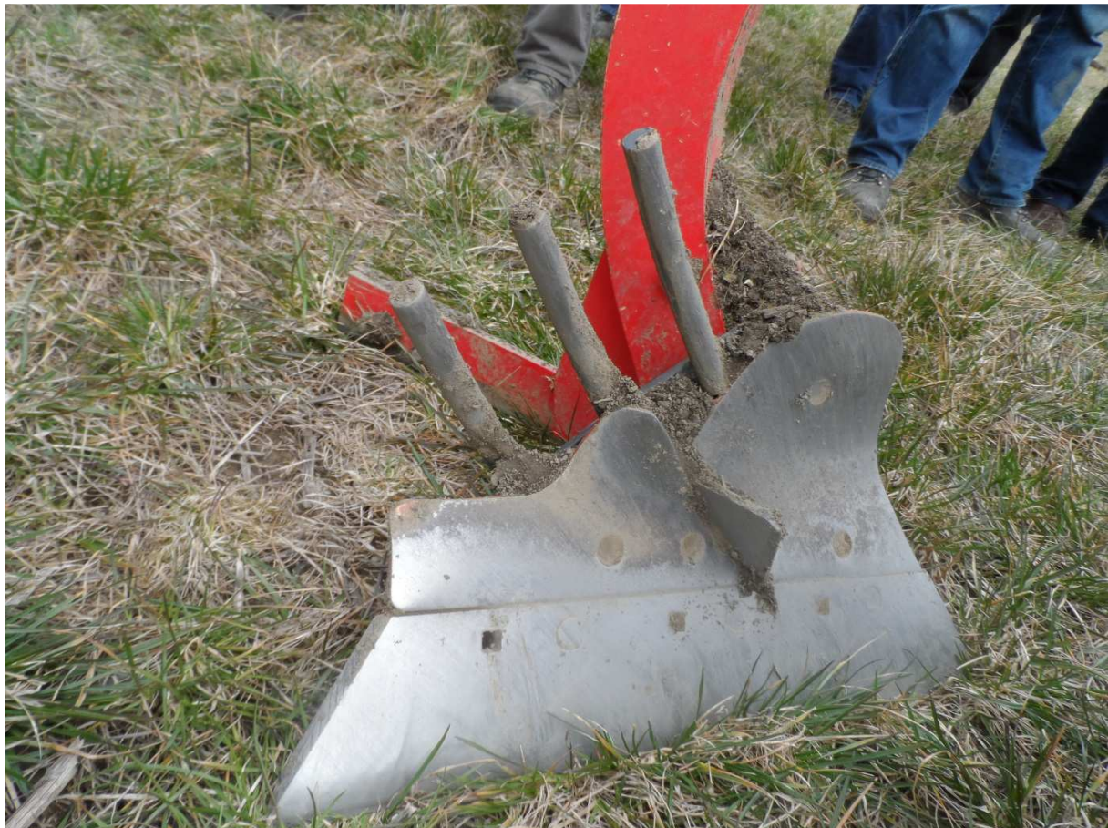
Abb.7: Zobel Stoppelhobel: Wendeschar, mit kurzem, unterteilten Streichblech und Streichblechverlängerung
