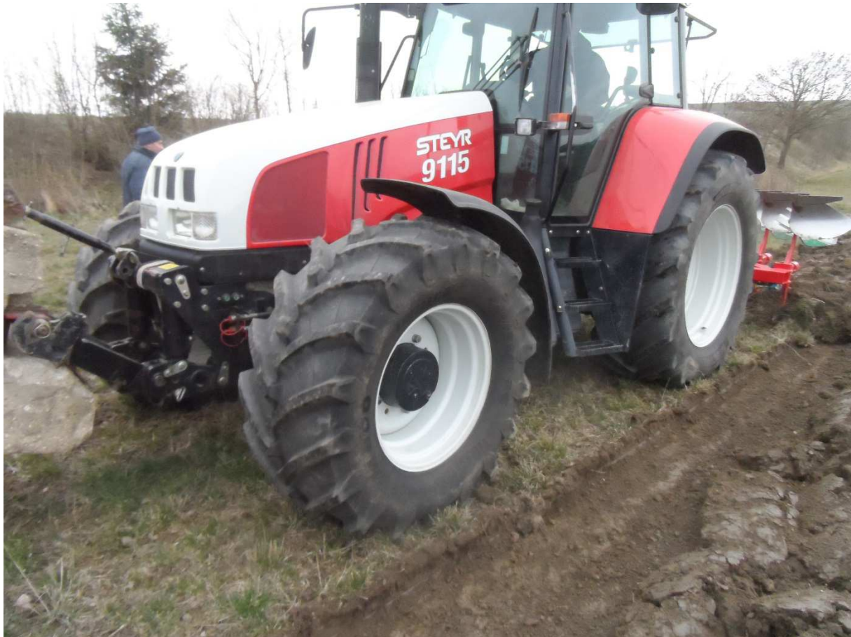
Abb.11: Ovlac mini in On-Land-Einsatz, teilweise Verschmierung der Pflugsohle
