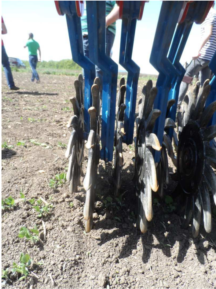
Abb.3: Hatzenbichler Rotorstriegel Spider: Unkräuter zwischen den Sternen sollen durch lockere Erde bedeckt werden – Mindest-Arbeitstiefe und -geschwindigkeit notwendig!
