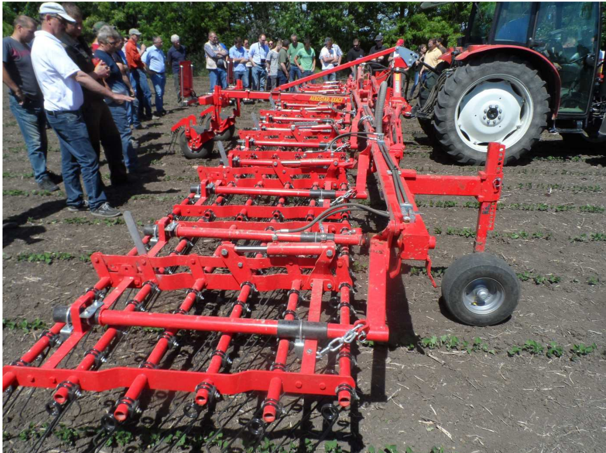
Abb.12: Einböck Aerostar-Exakt mit vorderen und hinteren Stützrädern, Oberlenker-Langloch, 600mm-Zinken, hydraulischer Verstellung, Fixierung der Striegelfelder
