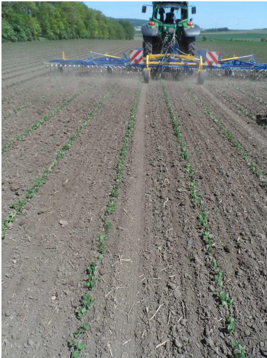
Abb.10: Treffler Präzisions-Zinkenstriegel mit 9,2 m Arbeitsbreite – mit einer theoretischen Überlappung von 10 cm auf jeder Seite zur nächsten Fahrt; Spuren der hinteren Stützräder sichtbar;
