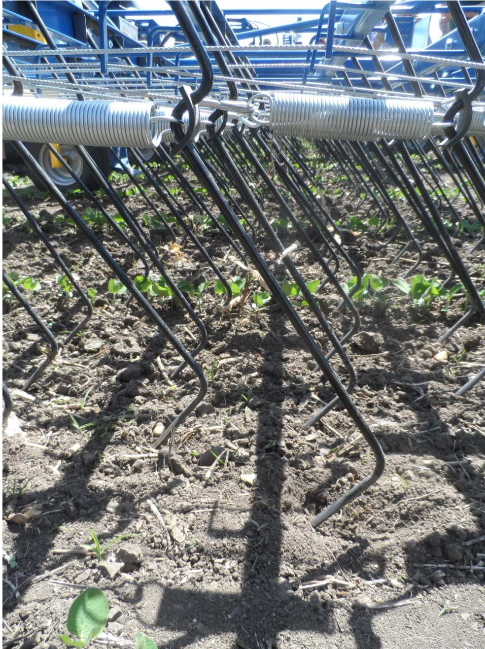
Abb.11: 90 Grad Abwinkelung des Verschleißstückes – der Boden gleitet z.T. am Verschleißstück in die Höhe, gute Striegelwirkung bei Vorführung
