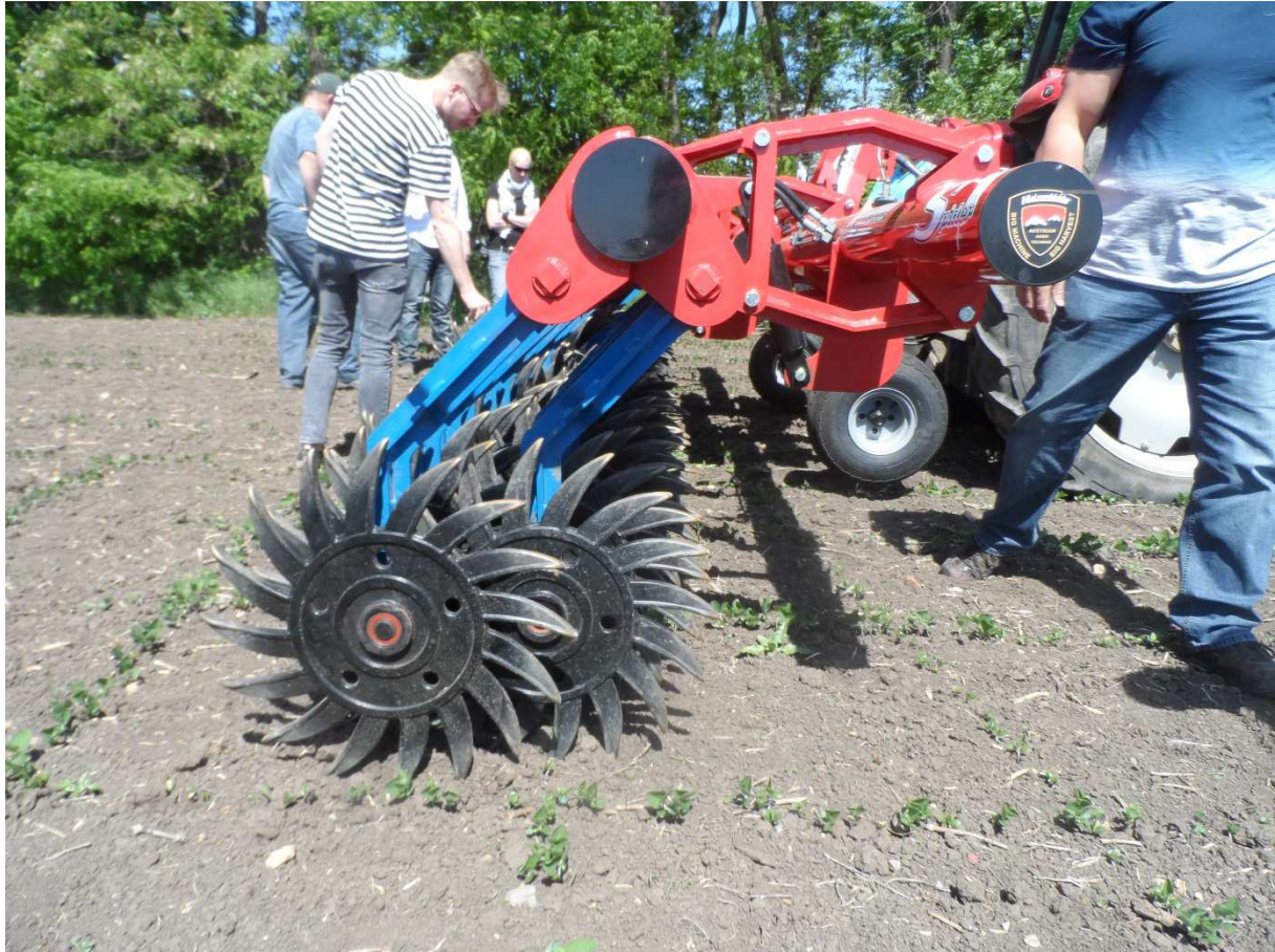
Abb.2: Hatzenbichler Rotorstriegel Spider Einzeln aufgehängte Rollsterne, in zwei Reihen angeordnet
