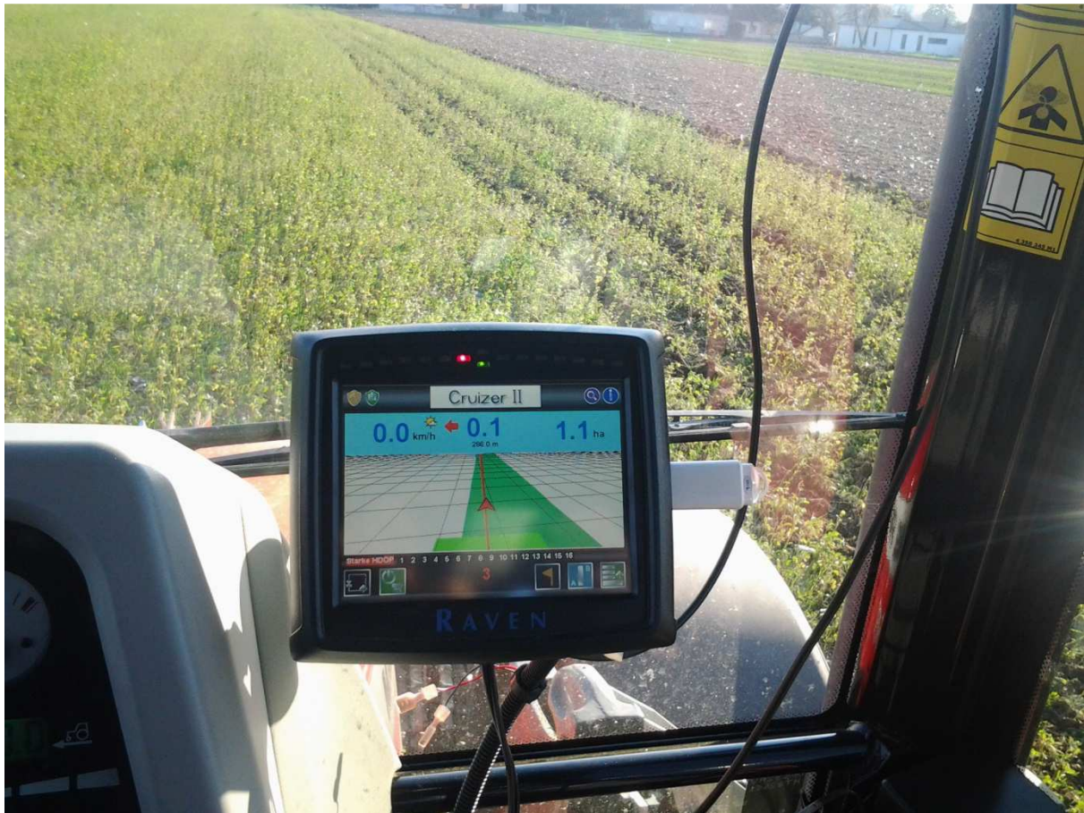
Abb.3: GPS-Einsatz beim Strip Till in der stehenden Begrünung
