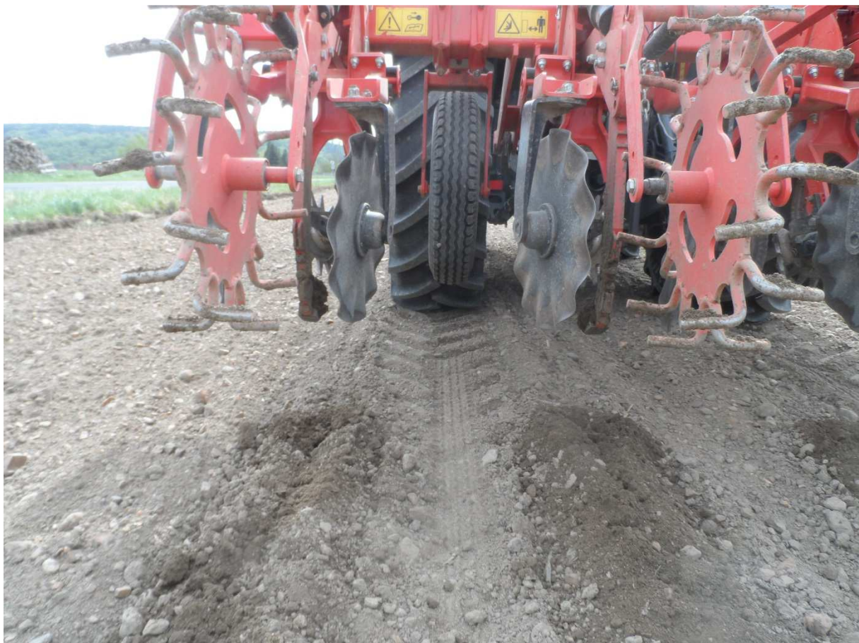
Abb.5: Mitteltiefe Lockerung im Frühjahr nach einer flachen Saatbeetbereitung, Strip-Till im Abstand von 75 cm
