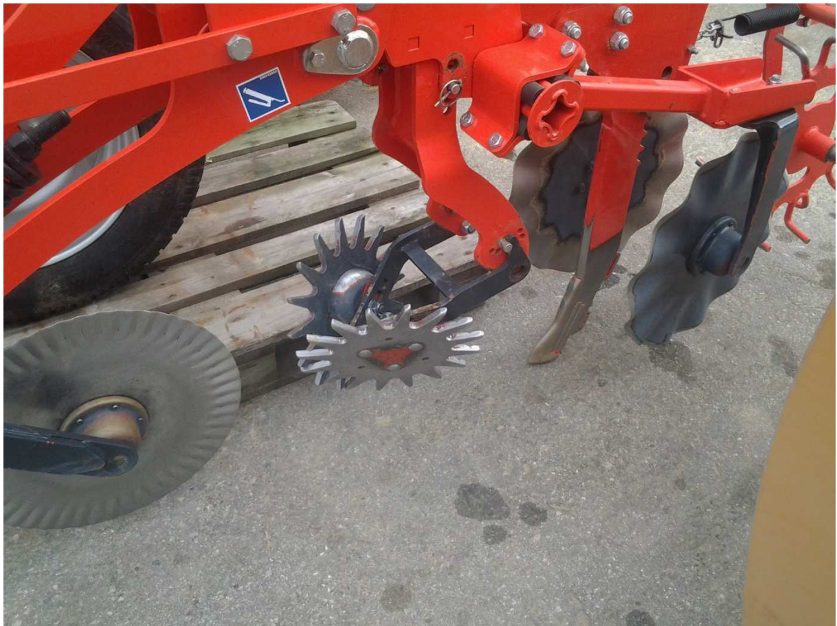
Abb.1: Strip Till Gerät mit Schneidscheiben, Räumsternen, Lockerungszinken mit benachbarten Coulter-Scheiben und Andruckrolle
