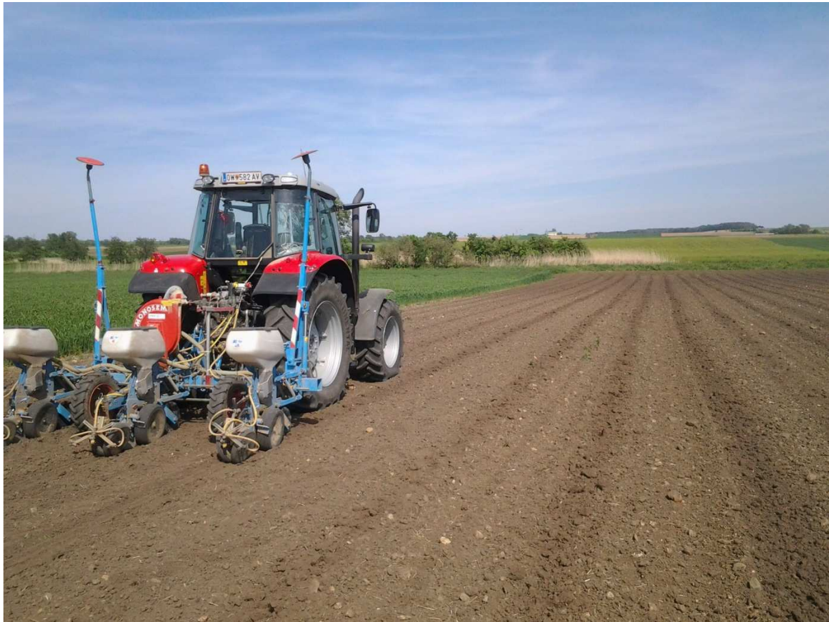
Abb.4: Saat von Ölkürbis nach Strip Till im Herbst und einer flachen, ganzflächigen Saatbeetbereitung im Frühjahr
