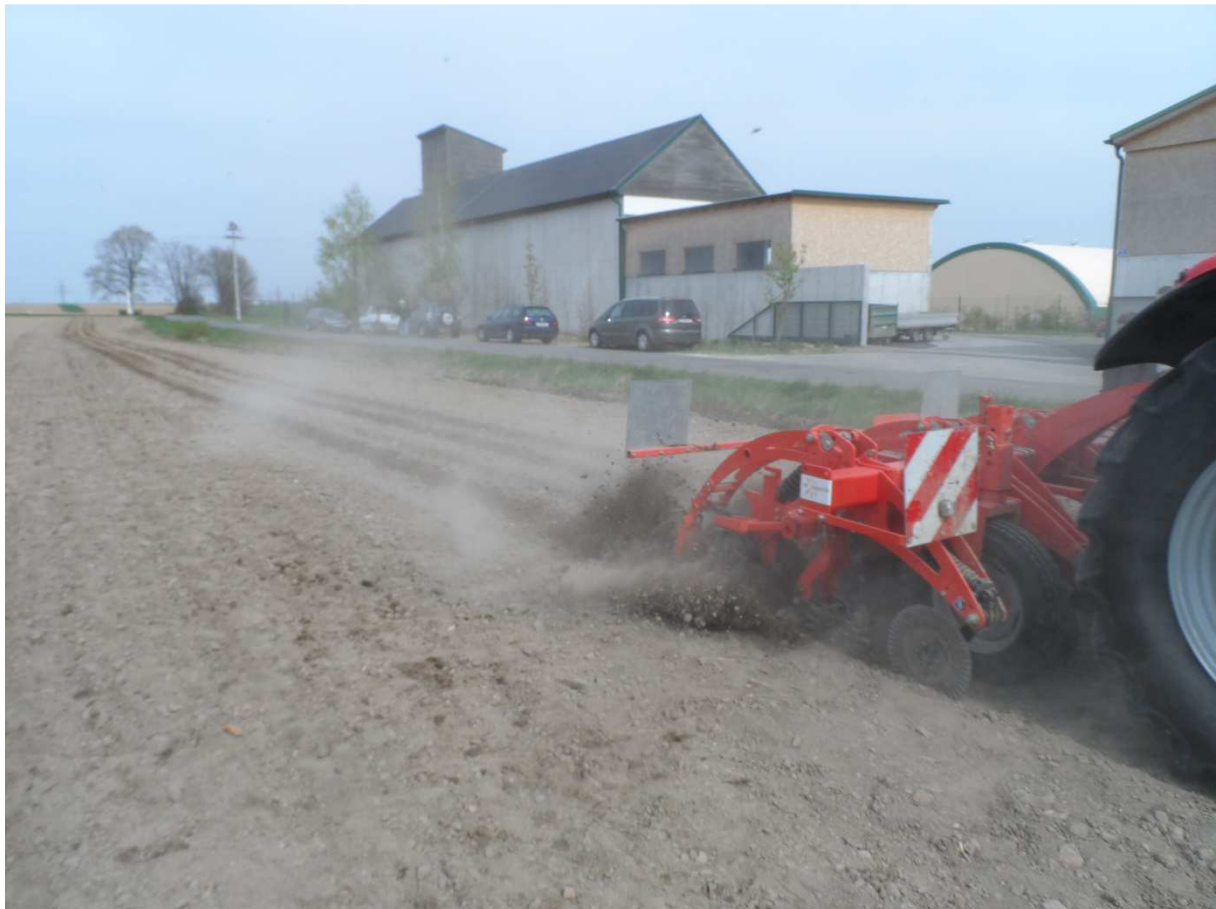
Abb.7: Strip Till nach einer flachen Saatbeetbereitung im Frühjahr - ausreichend Feinerde durch hohe Geschwindigkeit
