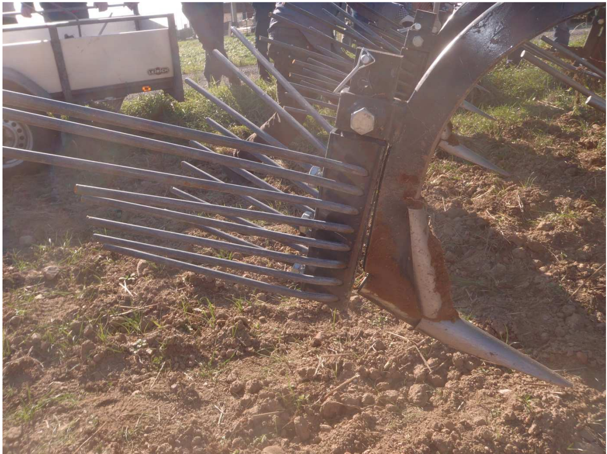
Abb.4: Dammformer, die hinter den Zinken angebracht werden, bilden Dämme Aufnahmedatum: 1.10.2015
