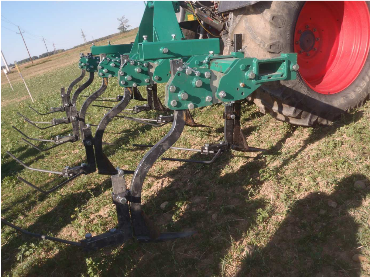
Abb.1: Punktförmige Bodenlockerung, Bekämpfung von Unkräutern durch runde Stäbe Aufnahmedatum: 1.10.2015
