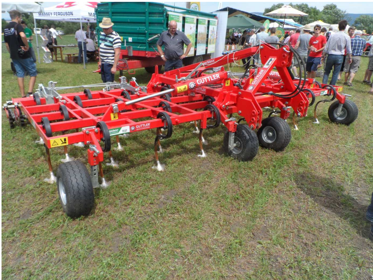
Abb.1: Leichtgrubber mit variabler Anbauhöhe, Front-Stützrädern, Doppelfederzinken mit Gänsefußscharen, Nachlaufstrielgel und Kunststoff-Nachlaufwalze
