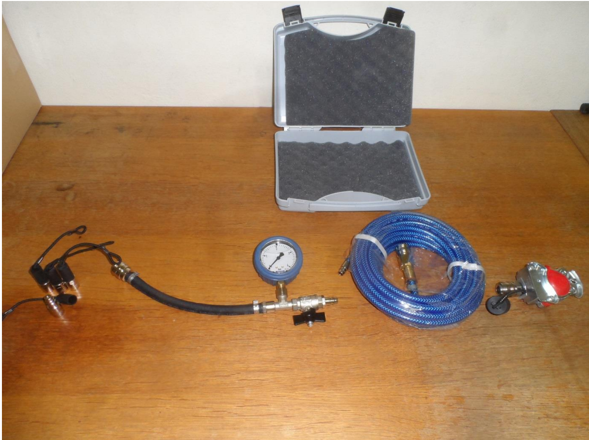
Abb.4: Manuelles Reifendruck-Regelset bestehend aus (von rechts nach links): Kupplungskopf, Verlängerungsschlauch, Füll- und Ablasshahn samt Manometer, 4 Schnellfüllventilen
