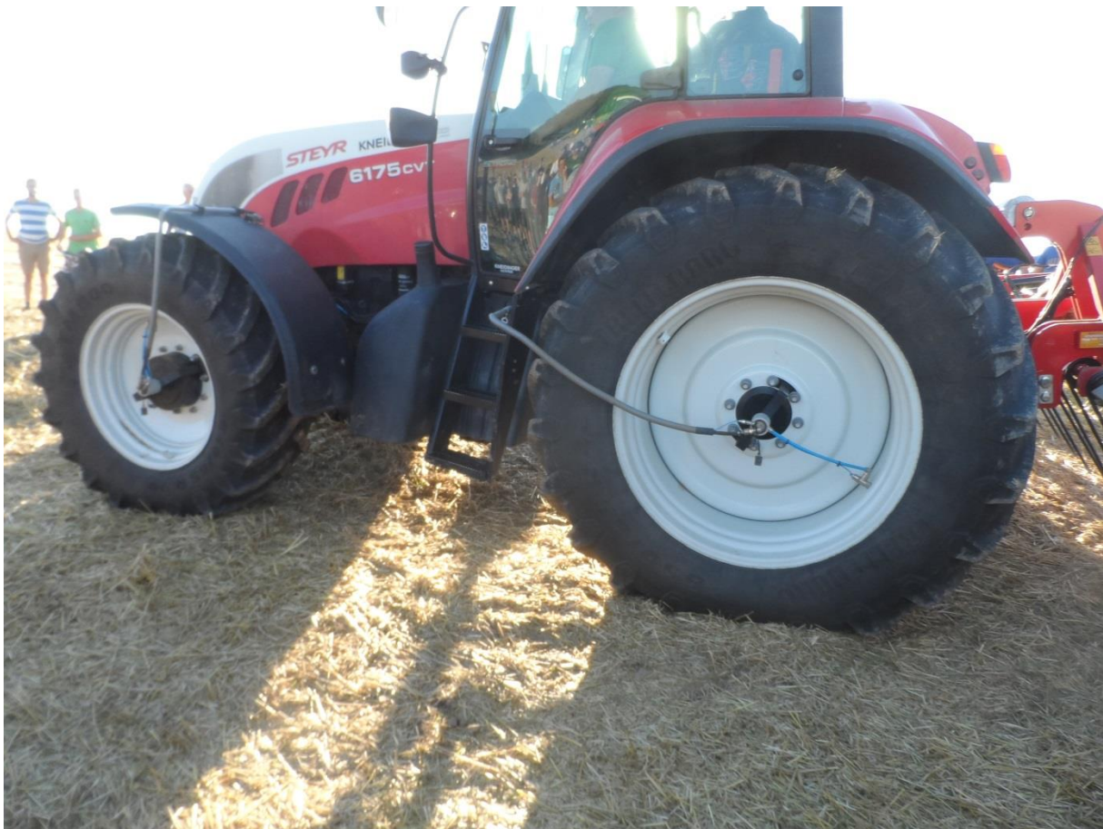
Abb.5: Traktor mit Reifendruck-Regelanlage - -außenliegende Schlauchführung, Zweileiter-System
