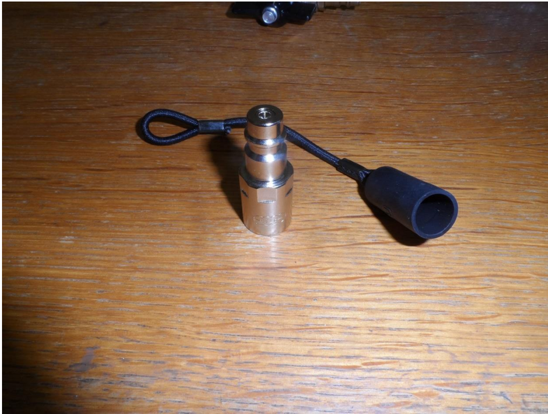
Abb.3: Schnellfüllventil samt Staubkappe zur schnellen Anpassung des Reifenfülldruckes
