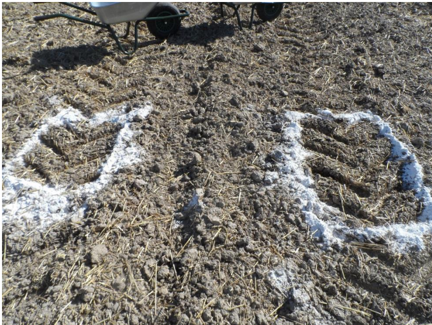
Abb.1: Links: Reifen mit 1,6 bar: 3 Stollenpaare im Bodeneingriff Rechts: Reifen mit 0,8 bar: 4 Stollenpaare im Bodeneingriff
