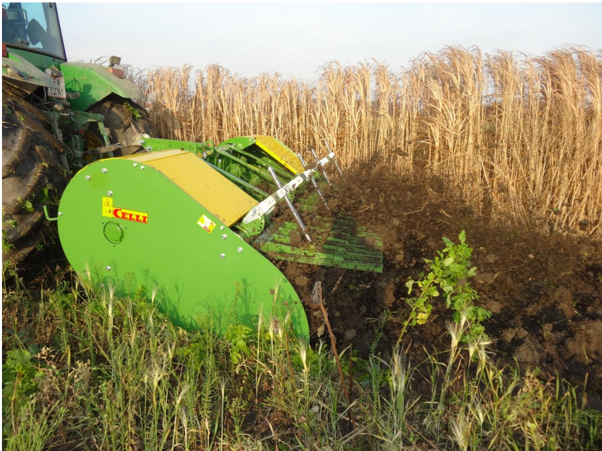
Abb.2: Umbruch einer Zwischenfrucht auf schwerem Boden mit der 3m-Spatenmaschine (Traktorleistung 180 PS/ 132 kW, 37 cm Arbeitstiefe, 2,4 km/h)
