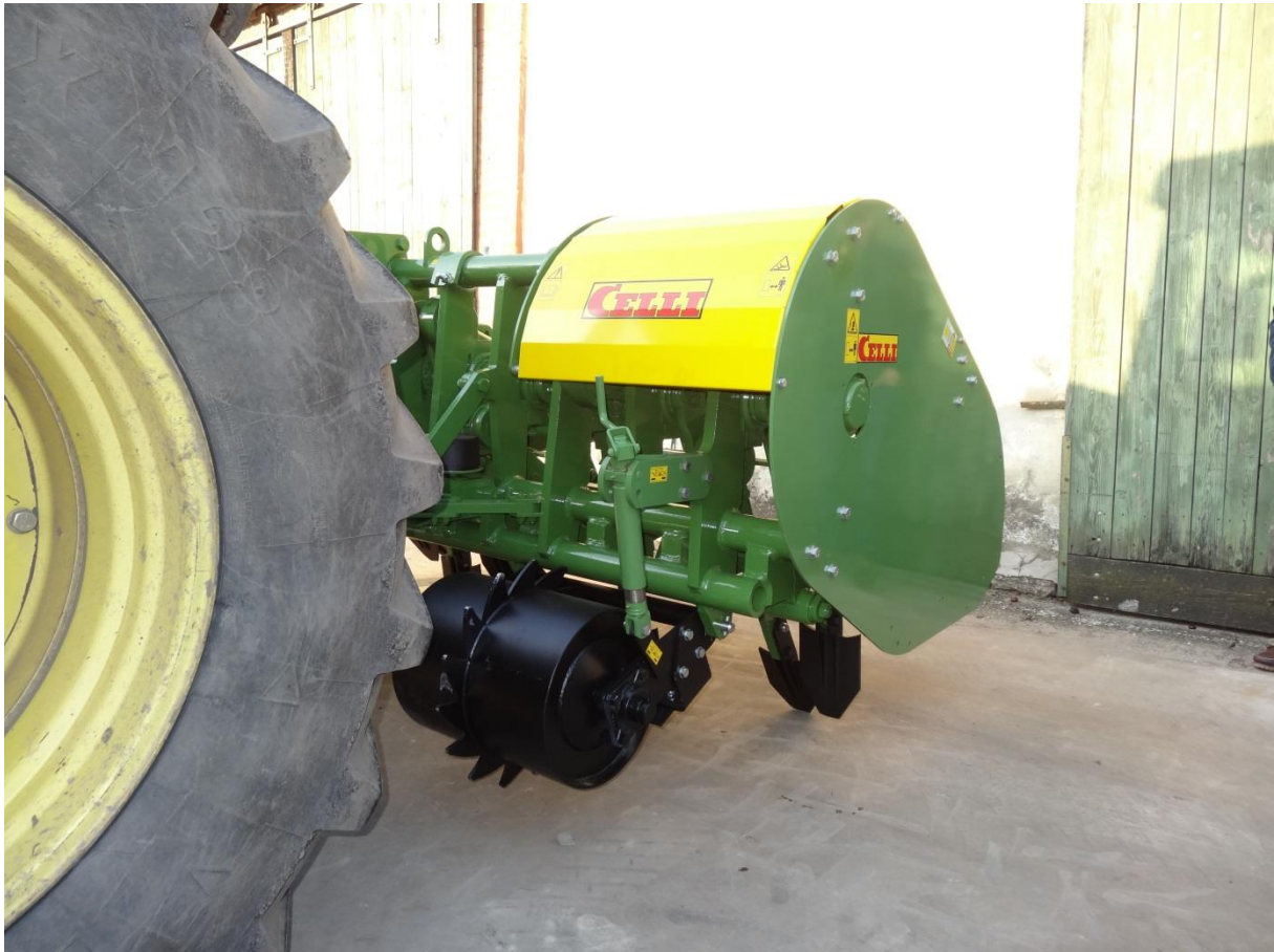
Abb.1: Spatenmaschine mit Stützwalze sowie Kurbelwelle mit Spaten
