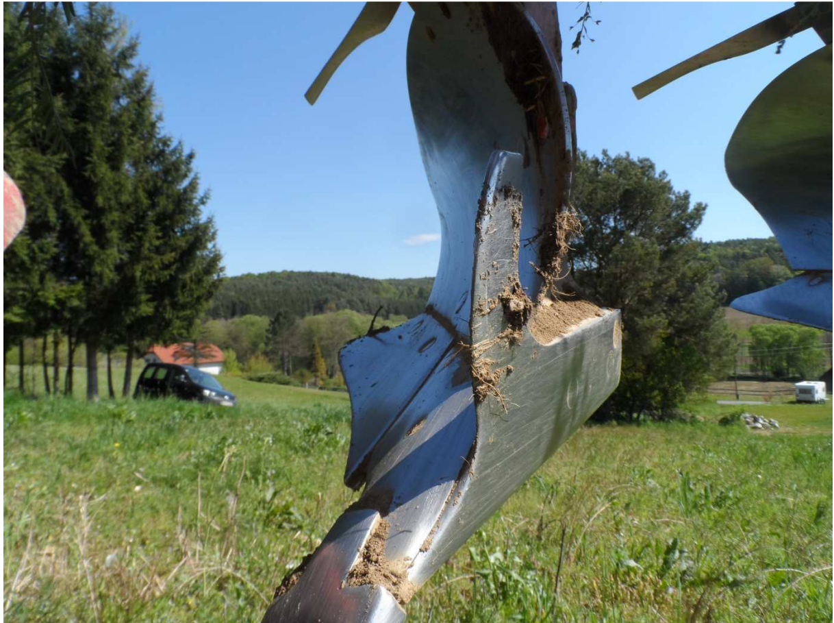
Abb.4: Anlagenseche schneiden den Erdbalken senkrecht durch
