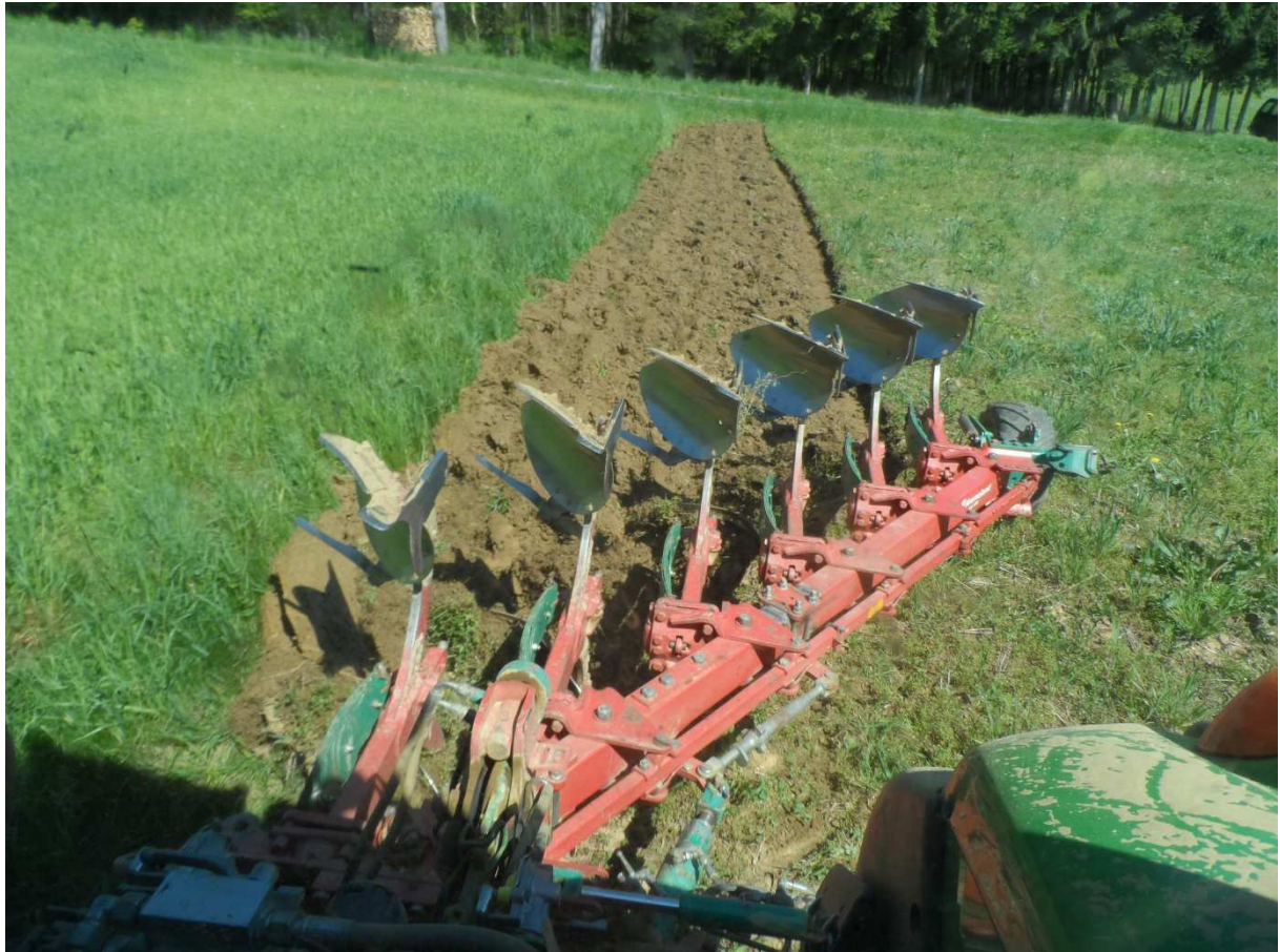
Abb.5: Arbeitsbild Schälplug beim Umbruch einer winterharten Begrünung im Frühjahr Aufnahmedatum: 26.4.2016
