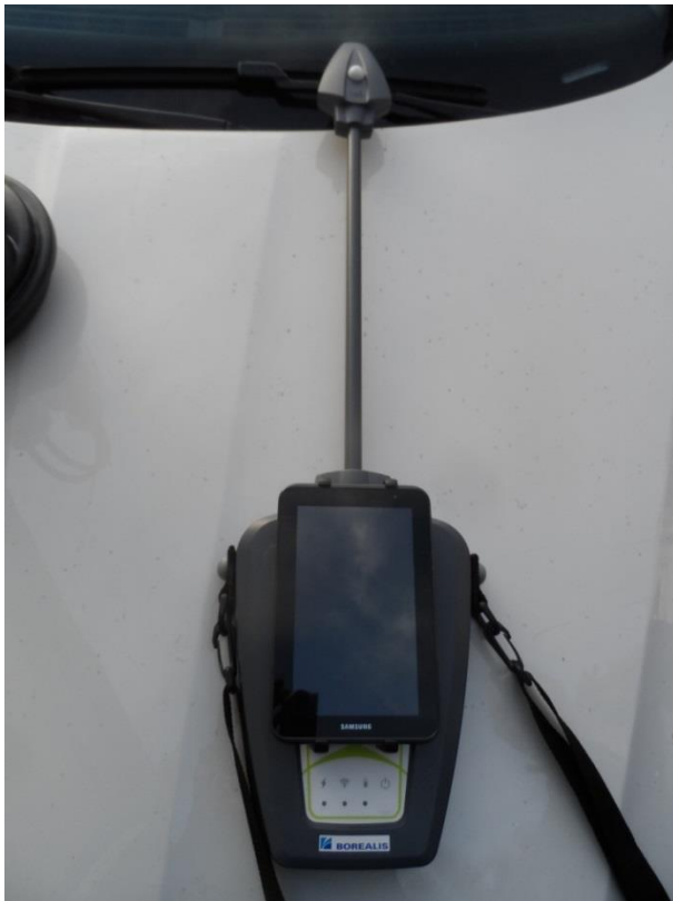
Abb.3: Der N-Pilot misst Globalstrahlung, Biomasse und die Grünfärbung der Kulturen
