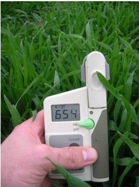
Abb. 2 Der N-Tester misst die Blattfarbe der Getreidepflanzen
