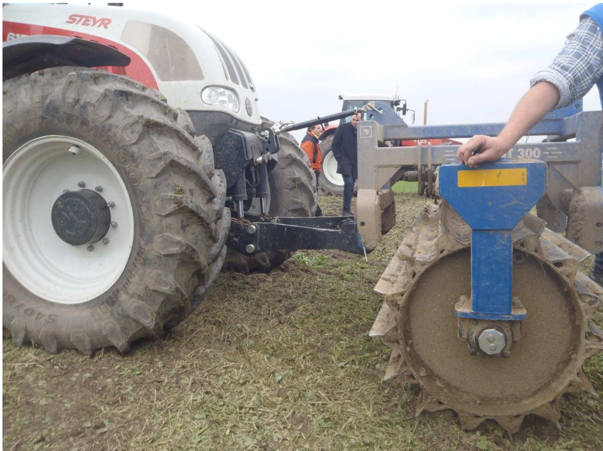
Abb.4: Messerwalze mit Beschwerungsmöglichkeit durch Wasserfüllung
