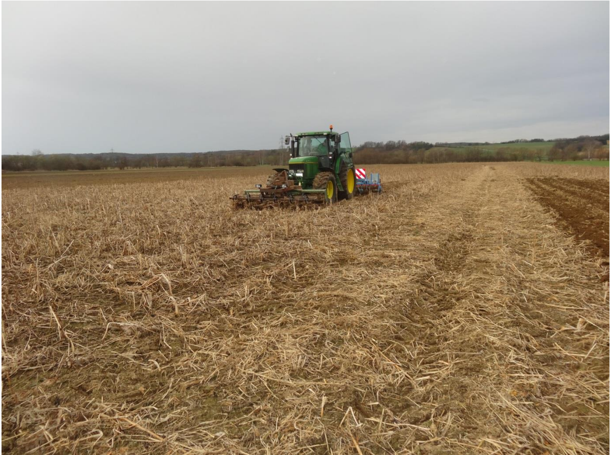
Abb.6: Verstopfung des Frontgrubbers bei der nicht bearbeiteten Parzelle Aufnahmedatum 4.4.2018
