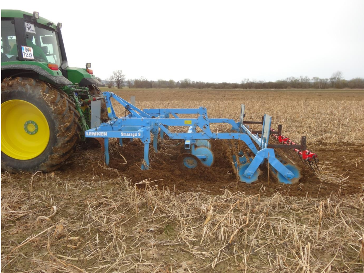
Abb.7: Verstopfungsfreies Zinkenfeld, geringe Verstopfungen am Nachlaufstriegel
