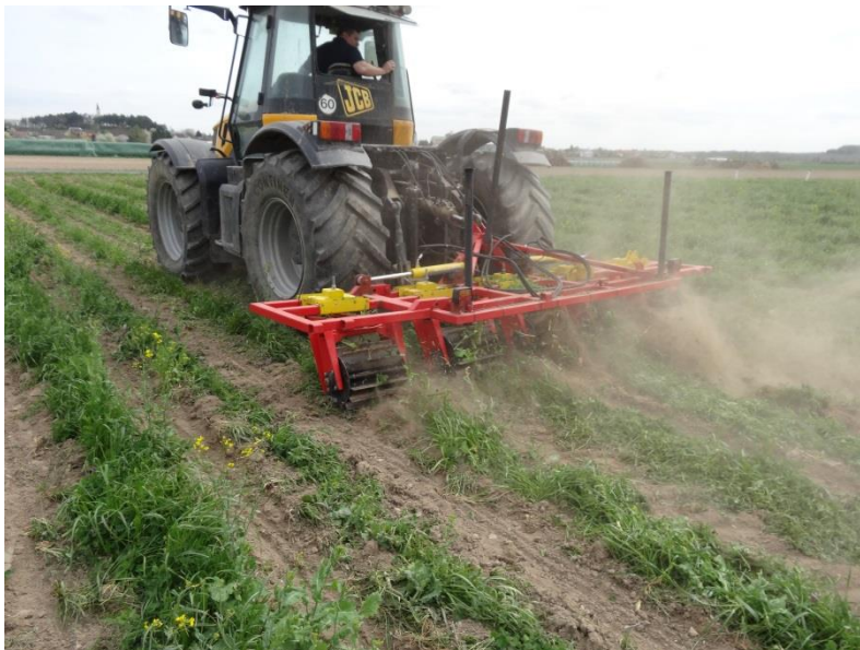
Abb.6: Streifen-Messerwalze einige Tag nach der Saat (nach dem Aufgang Verwendung eines kleineren Traktors, dessen Bereifung zwischen die Maisreihen passt) Aufnahmedatum: 17.4.2018
