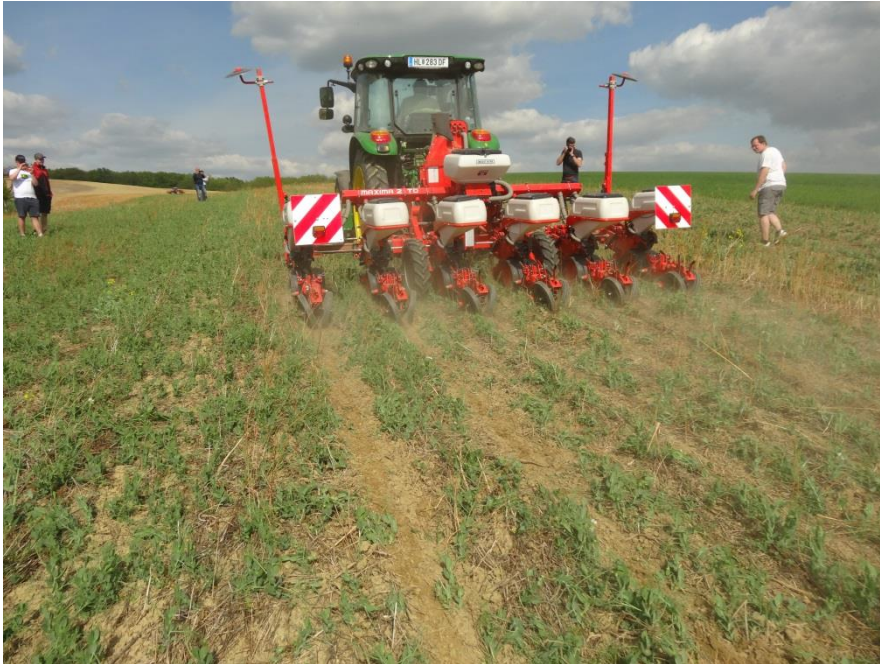
Abb.8: Arbeitsbild von Einzelkorn-Direktsämaschine 3 in winterharter Begrünung
