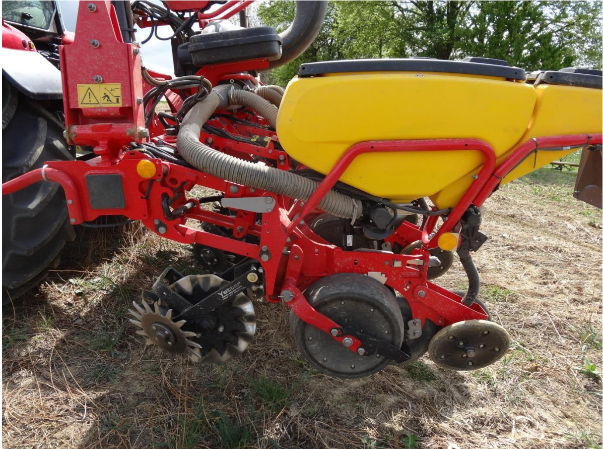
Abb.4: Einzelkorn-Direktsämaschine mit Sternrad-Klutenräumer, Coulter-Scheibe, Doppelscheiben-Säschar, Zwischendruckrolle und Andruckrolle
