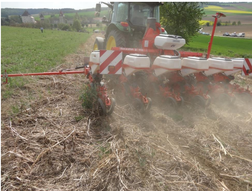
Abb.9: Arbeitsbild von Einzelkorn-Direktsämaschine 3 in abgefrosteter Begrünung
