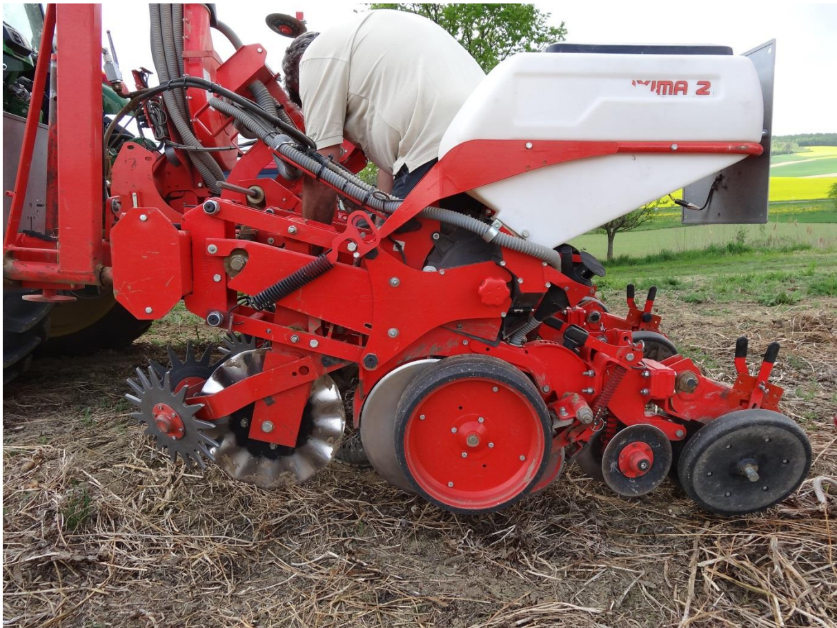
Abb.7: Einzelkorn-Direktsämaschine 3 mit Sternrad-Klutenräumer, Coulter-Scheibe, Doppelscheibenschar, Zwischendruckrolle, Räumscheiben und Andruckrollen
