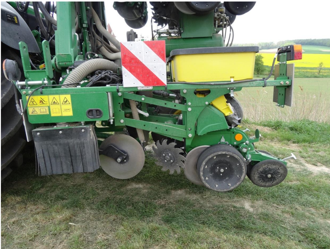
Abb.1: Einzelkorn-Direktsämaschine 1 mit glattem Scheibensech, Sternradklutenräumer, Doppelscheibensech und Andruckrollen (Schardruck-Balg verdeckt, im Hintergrund Kompressor erkennbar)
