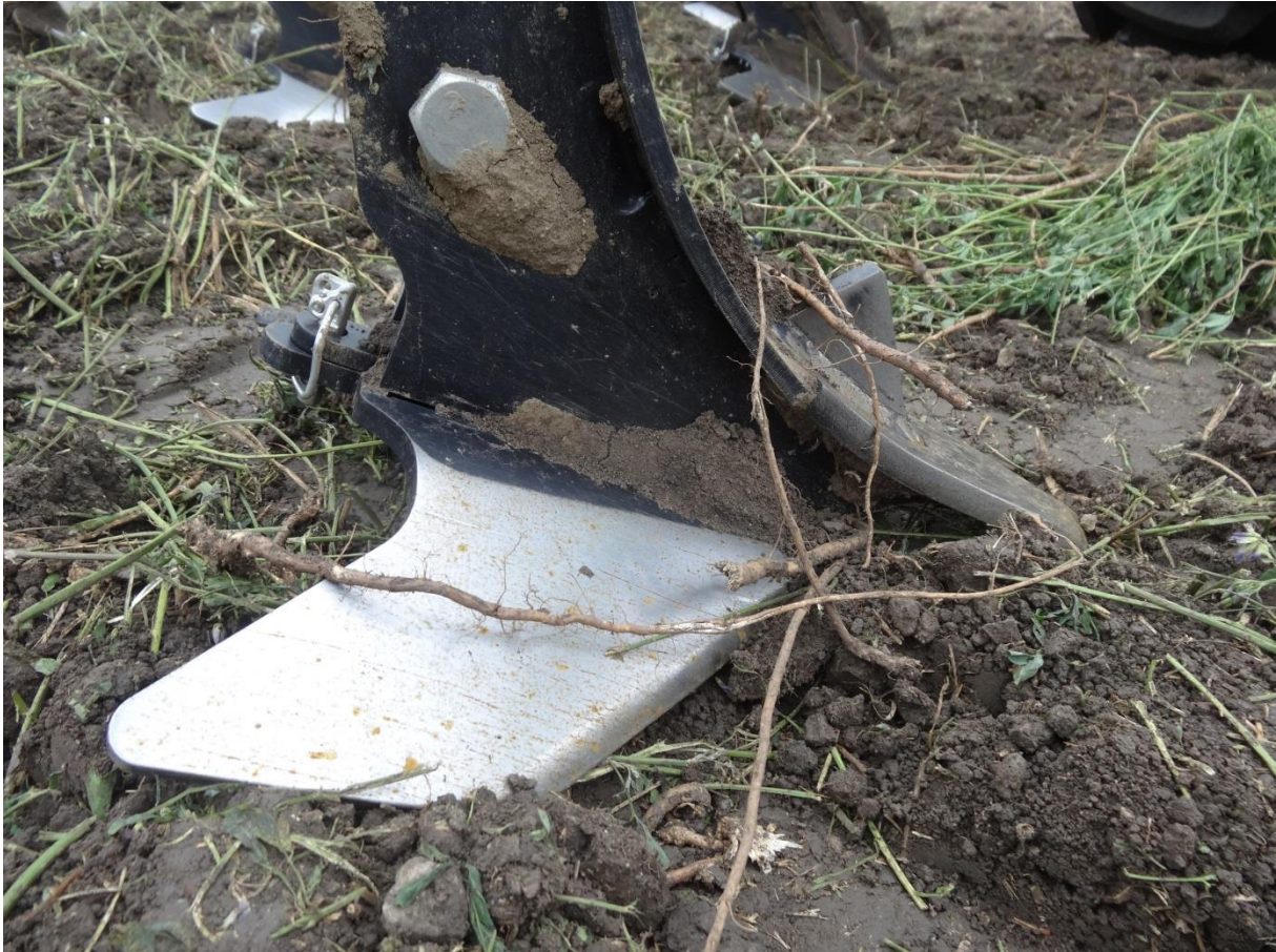
Abb.10: Schnellwechselsystem der Scharspitzen und der Flügelschare
