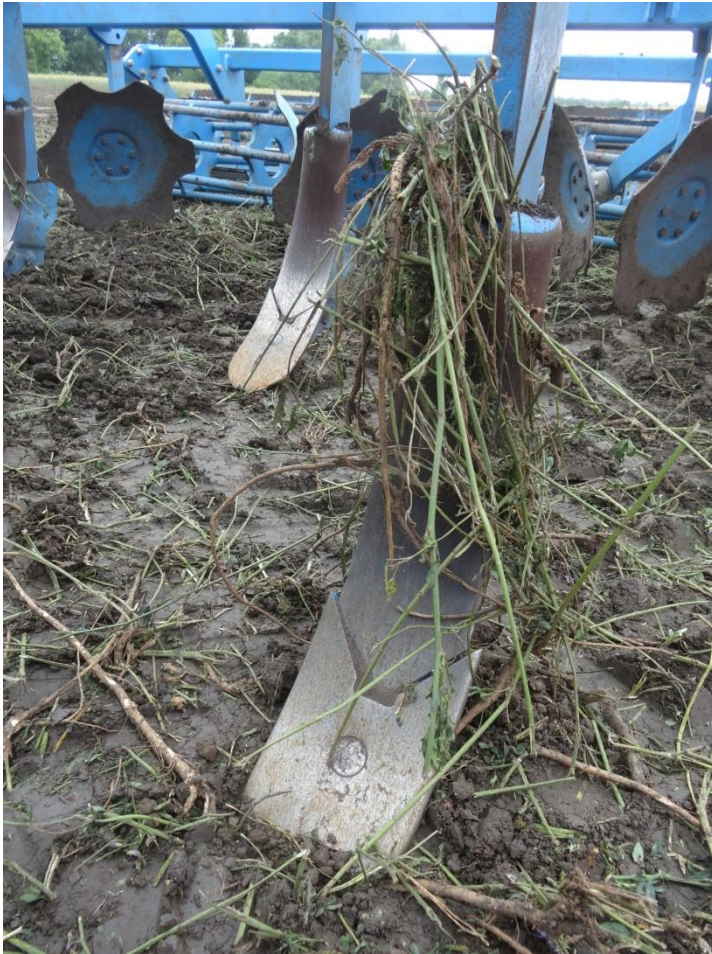
Abb.2: Breitschare ohne Flügel mit auswechselbarer Scharspitze auf Werkzeugträger verschraubt
