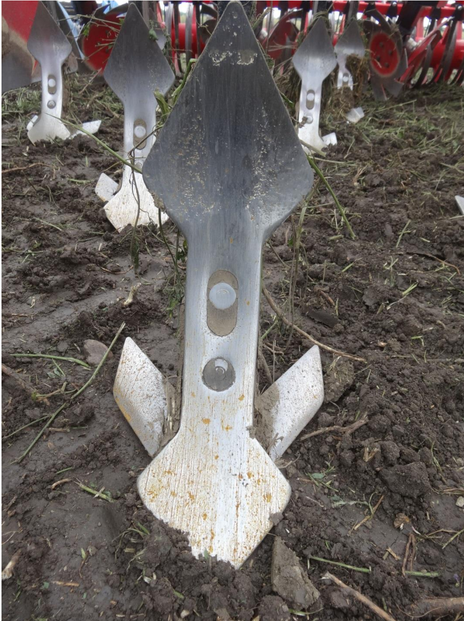
Abb.7: Doppelherzschare mit kurzen Flügelscharen, fest verschraubt
