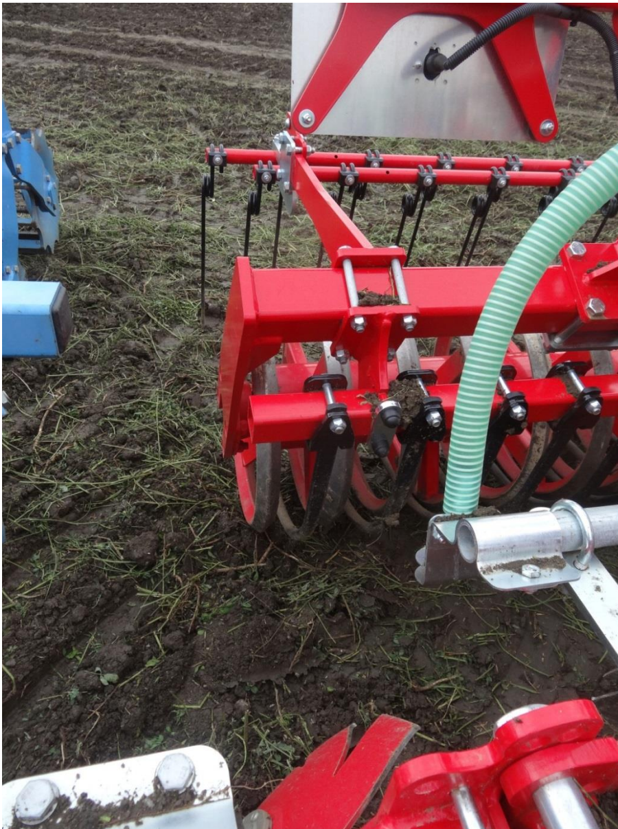
Abb.6: Prallteller mit Wurfrichtung nach hinten zur Packerwalze, dahinter Nachlaufstriegel
