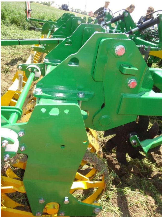
Abb.11: Abkoppelrahmen für die Nachlaufwalze
