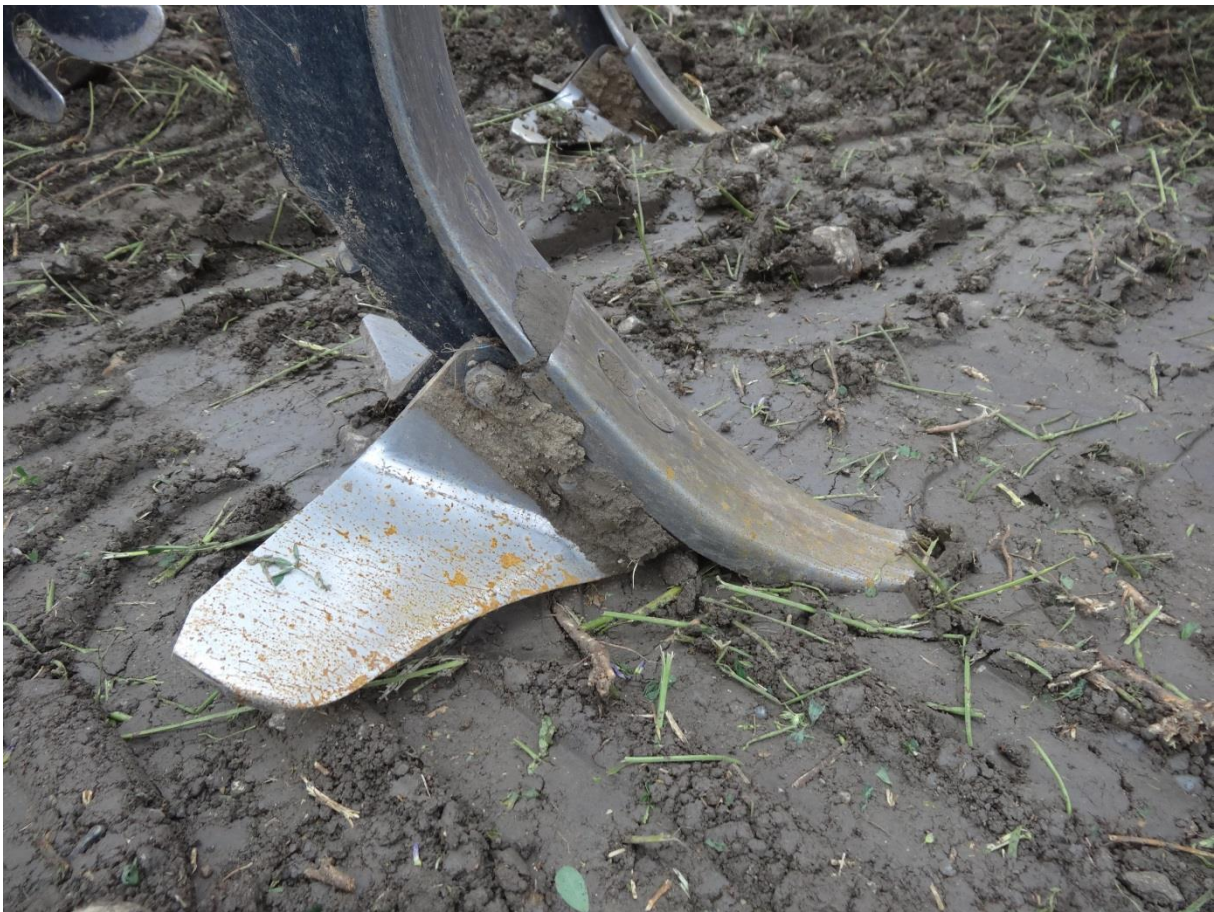
Abb.7: Zinken mit Flügelscharen, Untergriff der Scharspitzen, 27cm Strichabstand
