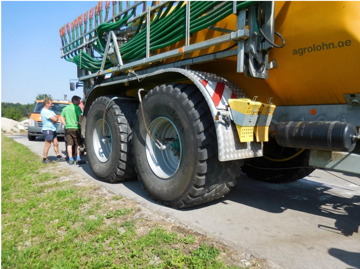
Abb.7: Güllefass mit Reifendruckregelung: z.B. bei Straßenfahrt 1,7 bar Quelle: Springer, NÖ LLWK
