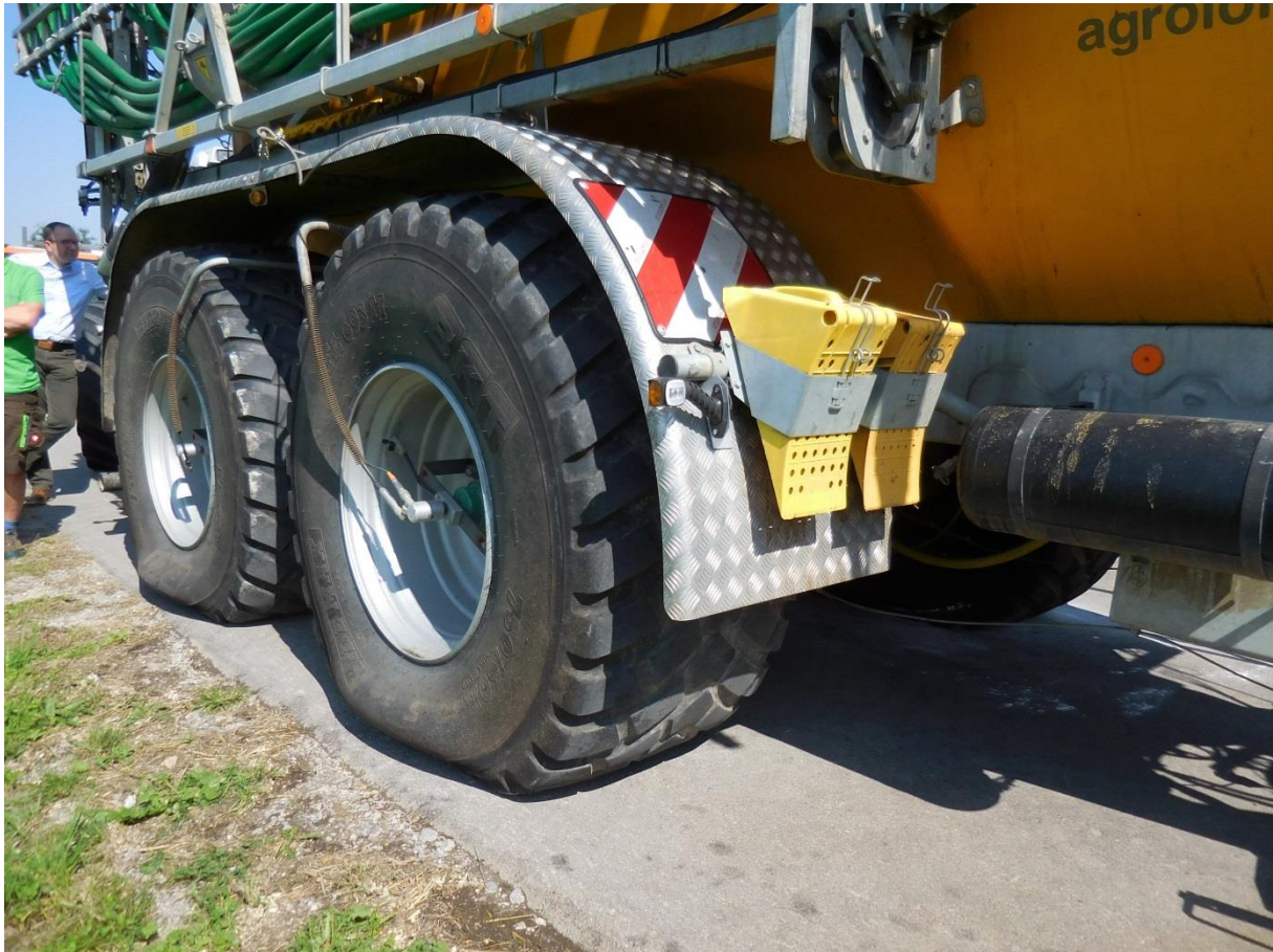
Abb.8: Güllefass mit Reifendruckregelung: z.B. bei Feldfahrt 1,0 bar Quelle: Springer, NÖ LLWK
