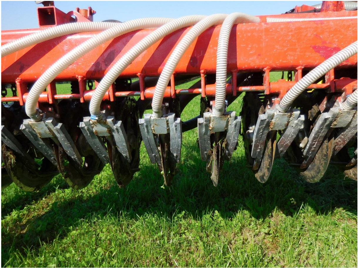
Abb.5: Scheibeninjektor Quelle: Springer, NÖ LLWK
