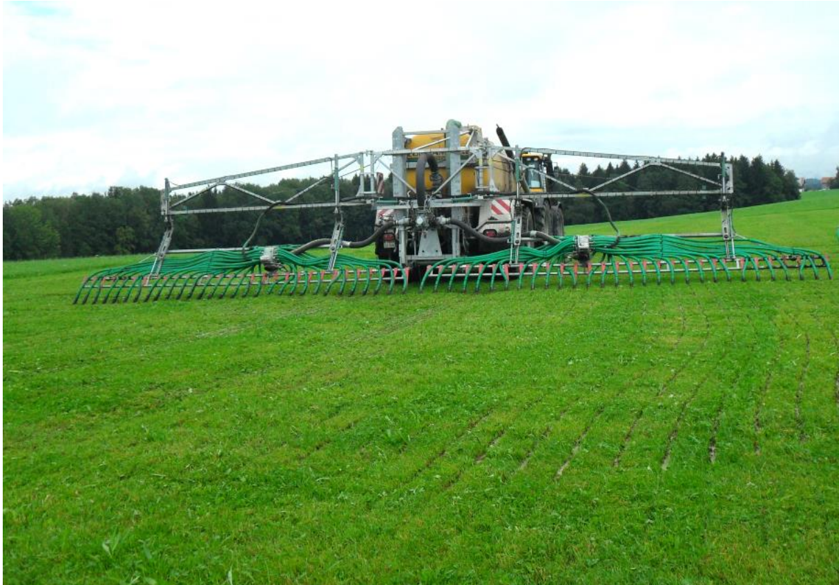
Abb.4: Arbeitsbild Schleppschuhverteiler Quelle: Hölzl, BWSB
