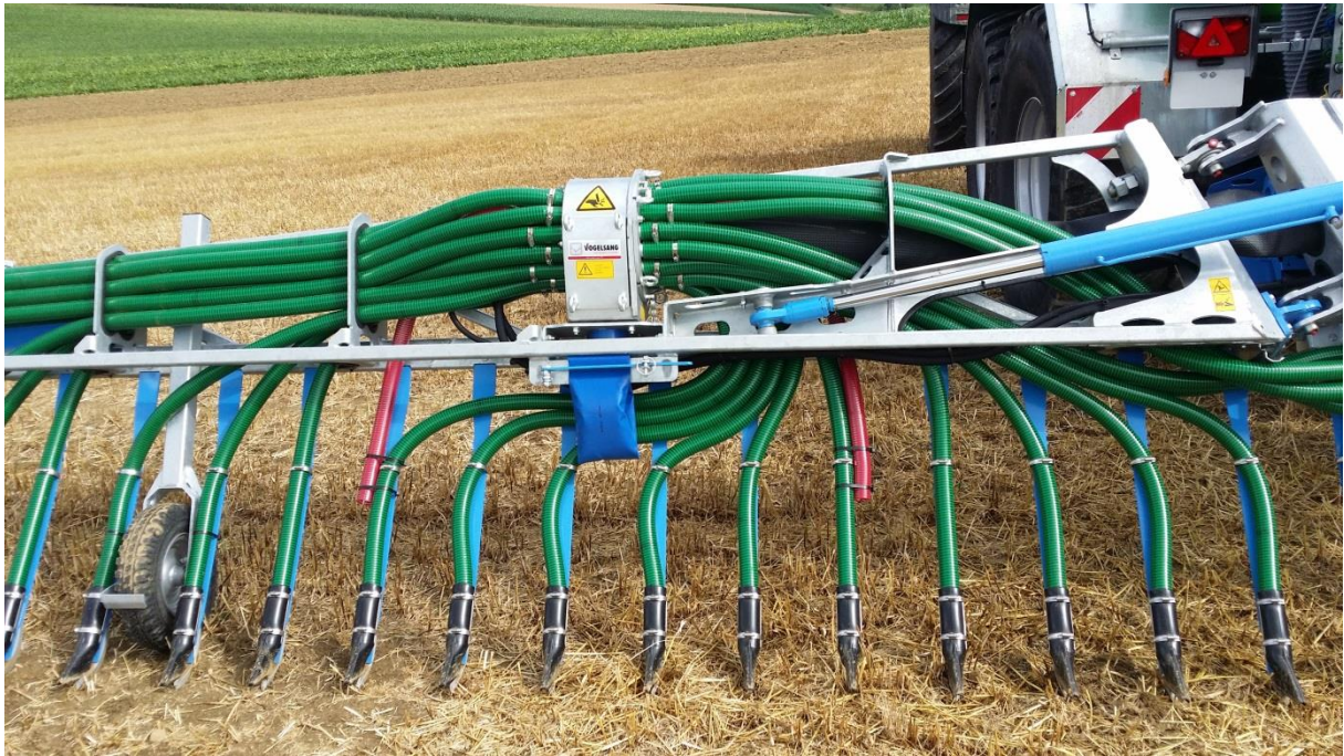
Abb.3: Schleppschuhverteiler Quelle: Springer, NÖ LLWK
