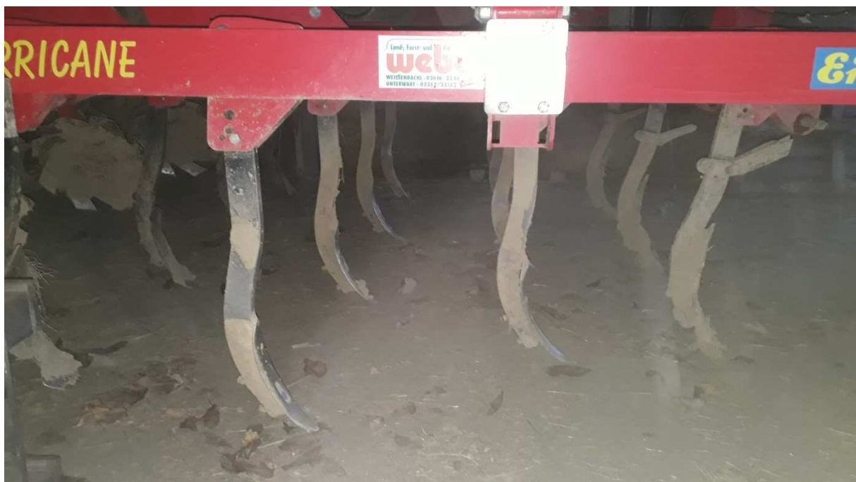
Abb.1: Verdoppelung des Strichabstandes durch Entfernung der Scherbolzen ersten und vierten Zinkenreihe
