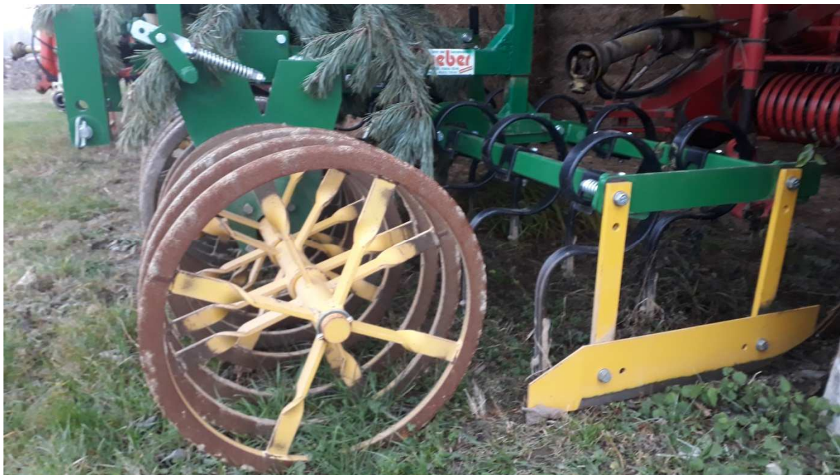
Abb.8: Frontkombination mit im Winkel verstellbaren Garezinken
