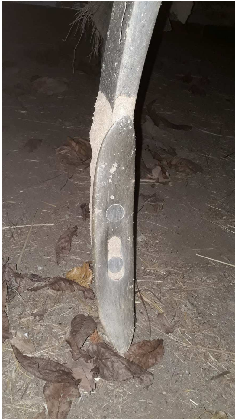
Abb.2: Schmalschare bei der tiefen Bearbeitung
