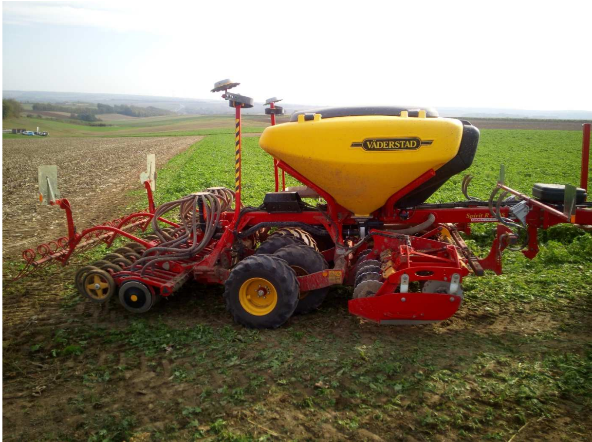
Väderstad Spirit R 300S mit Kurzscheibenegge, Packerwalze und Doppelscheiben-Säscharre mit Druckrolle sowie Nachlaufstriegel
