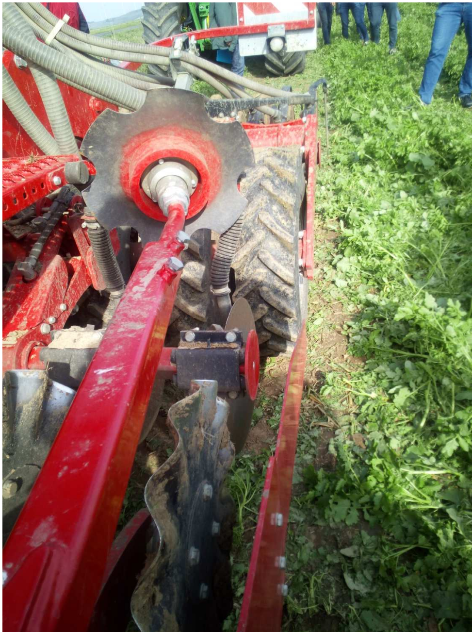
Horsch Pronto 3 DC: Coulter-scheibe als Vorwerkzeug vor Doppelscheiben-Schar
