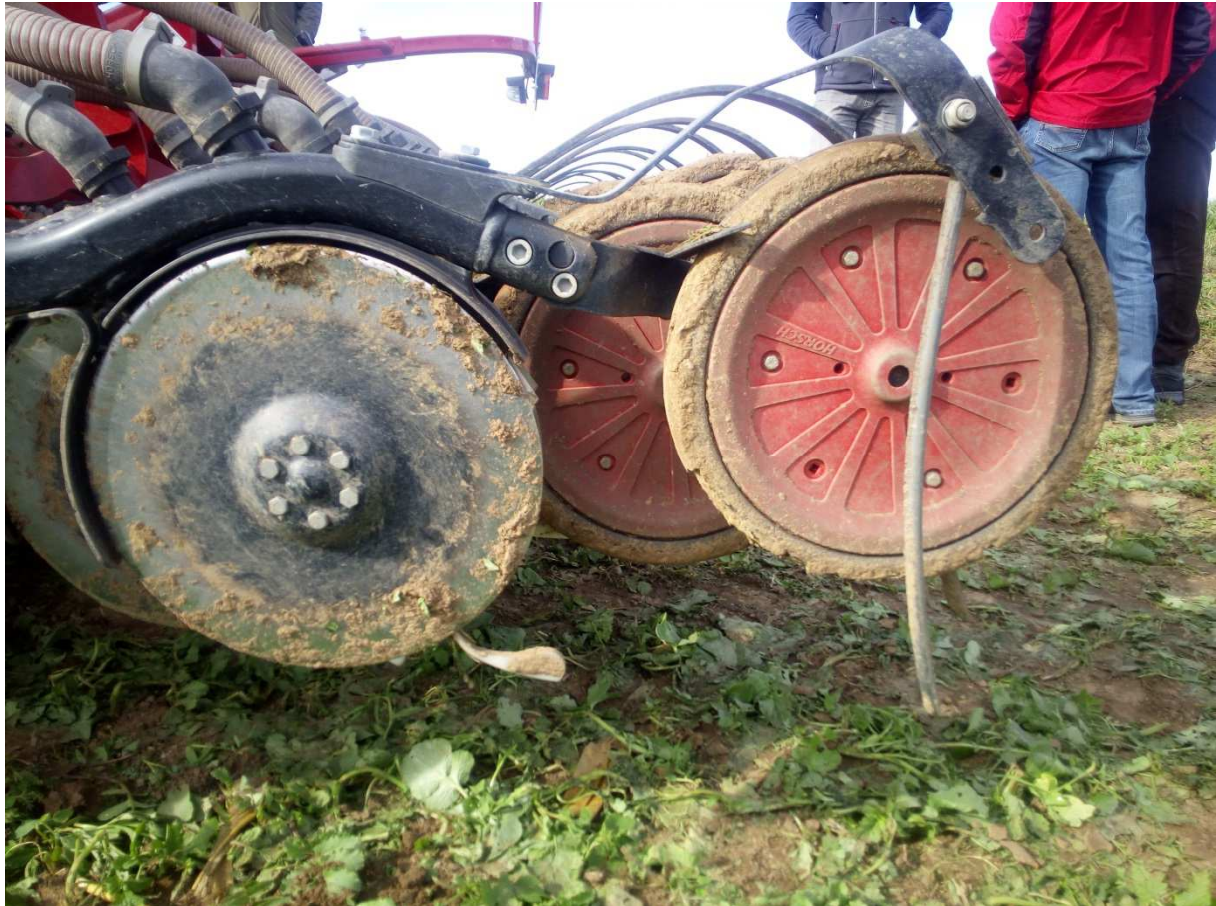
Horsch Pronto 3 DC: Doppel-Scheibenschar mit Saatgut-Zustreifer sowie Druckrolle mit Striegel
