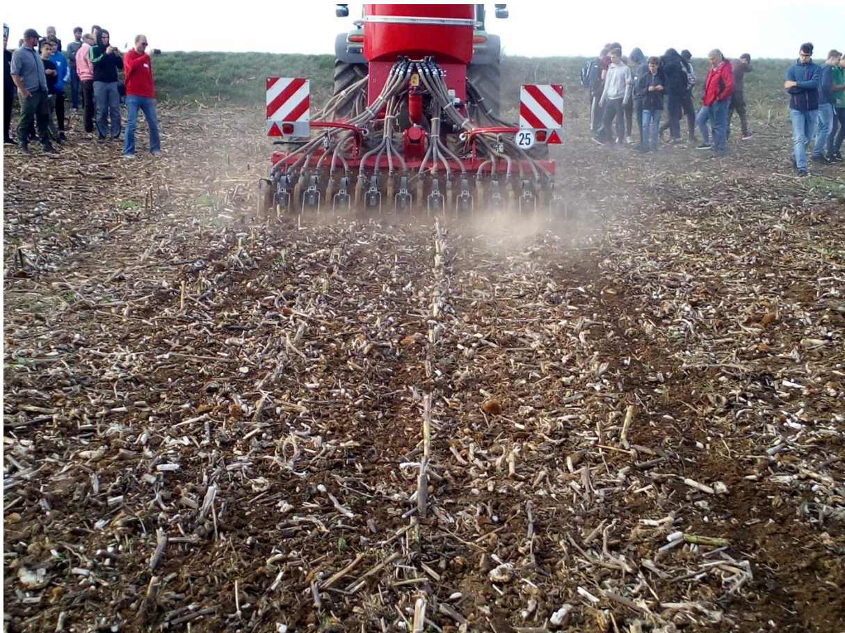
Horsch Pronto 3 DC: Einsaat in Sonnenblumen-Stoppel Links: ohne Einsatz der Vorwerkzeuge Rechts: mit Einsatz der Vorwerkzeuge
