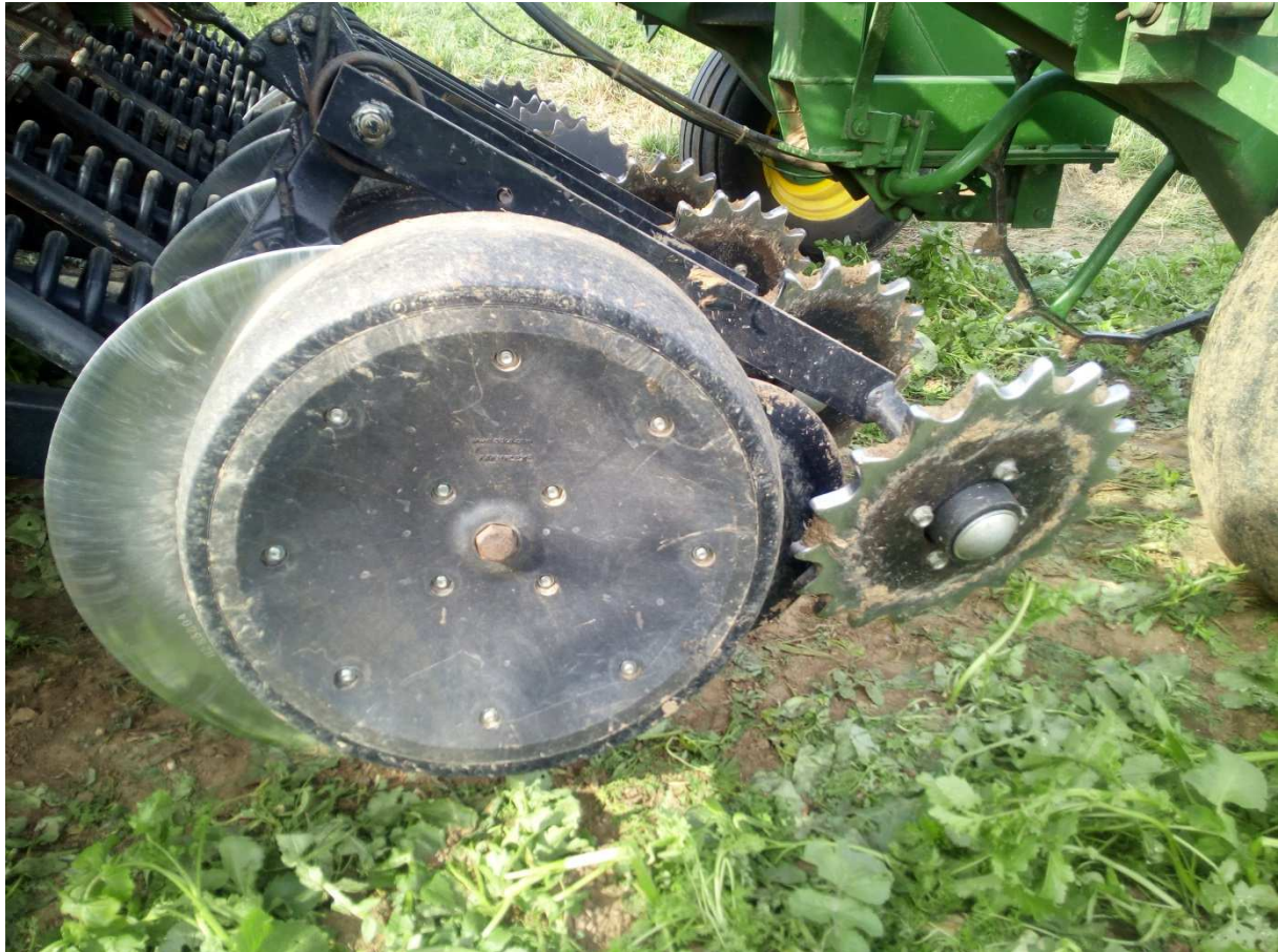
John Deere 750 A: Ein-Scheiben-Schar, Tiefenführungsrolle, Andruckrolle für das Saatgut, Stern-Zuräumer
