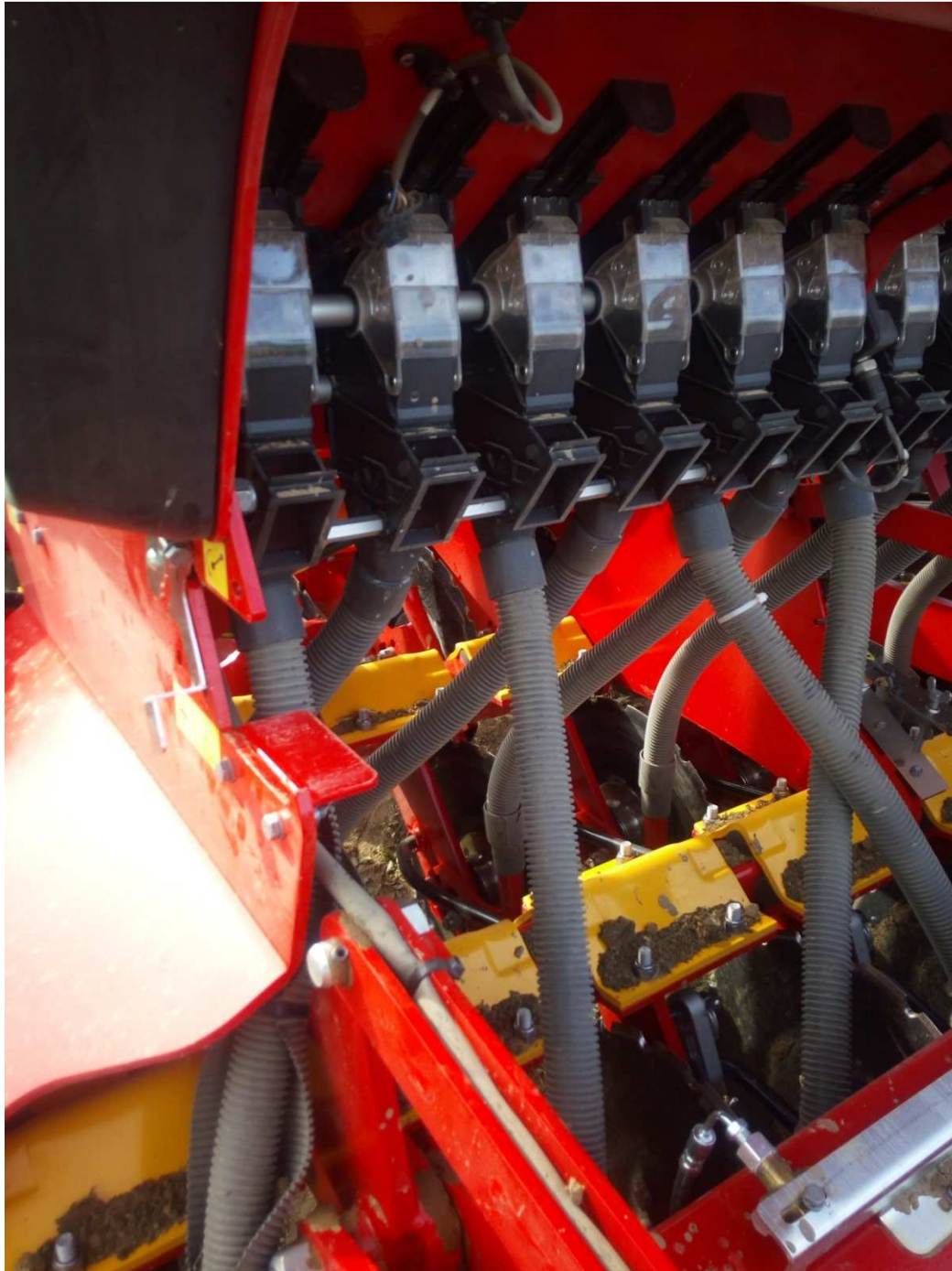
Väderstad Rapid 300C: mechanische Saatgutdosierung
