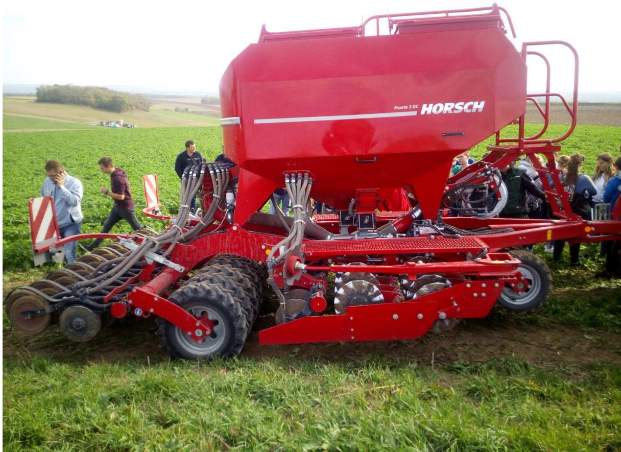
Horsch Pronto 3 DC mit Coulterscheiben, Düngerscharen, Reifenpacker, Doppelscheiben-Särscharen und Nachlaufstriegel
