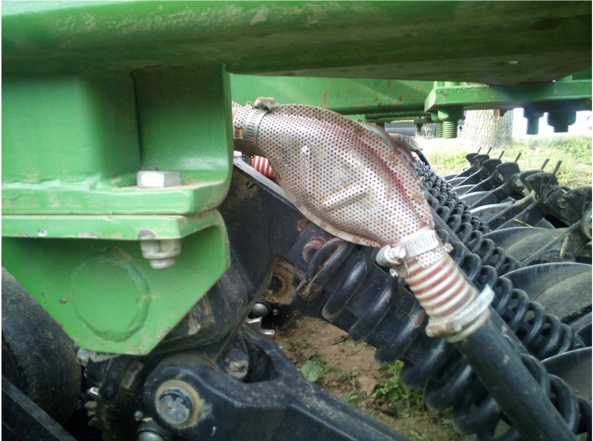
John Deere 750 A: Luftableitung in den Särohren, freier Fall des Saatgutes
