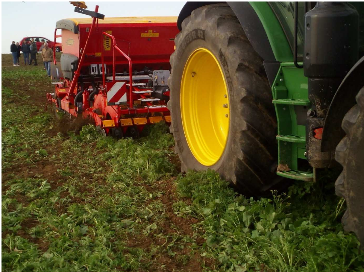
Väderstad Rapid 300 C: nicht ganzflächig arbeitende Kurzscheibenegge
