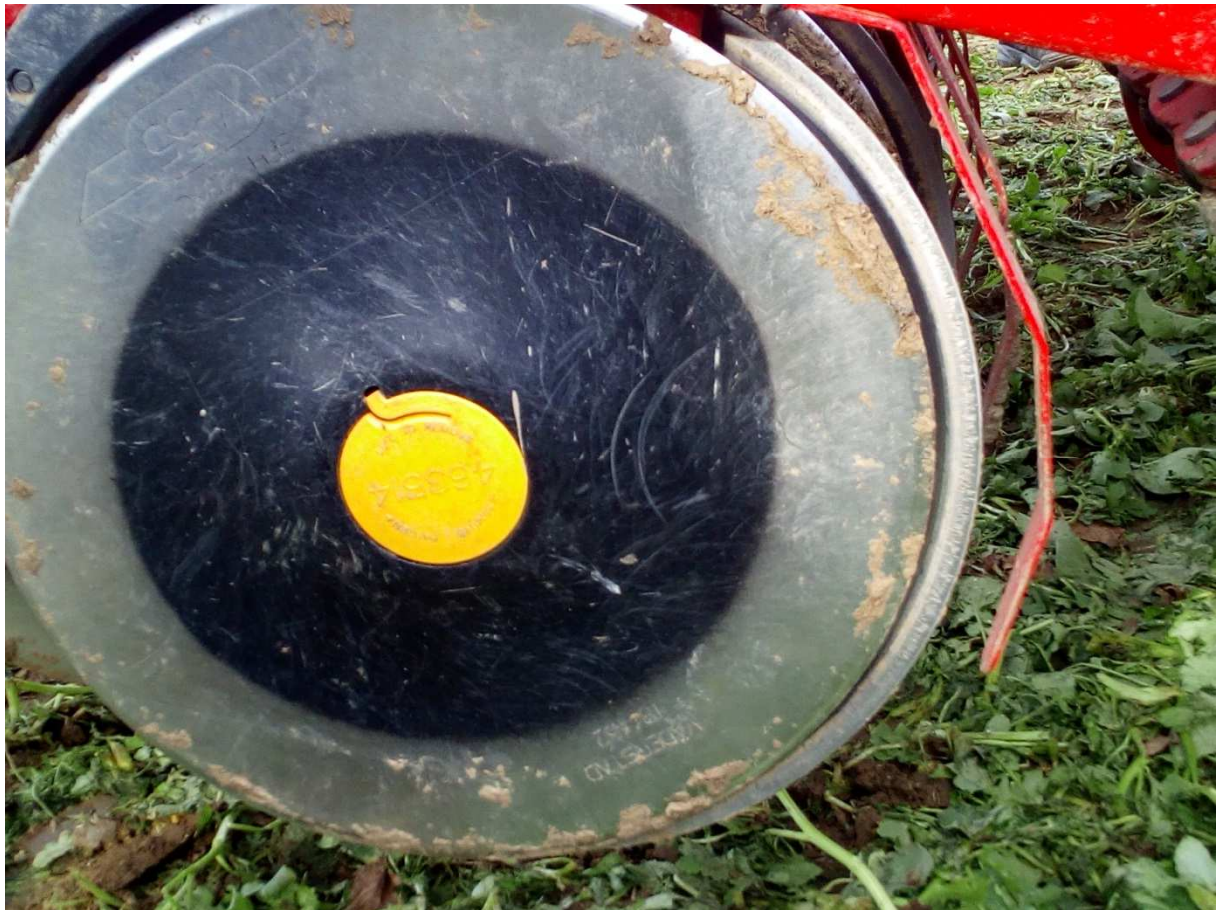
Väderstad Spirit R 300S: Off-Set Anordnung der Säscheiben
