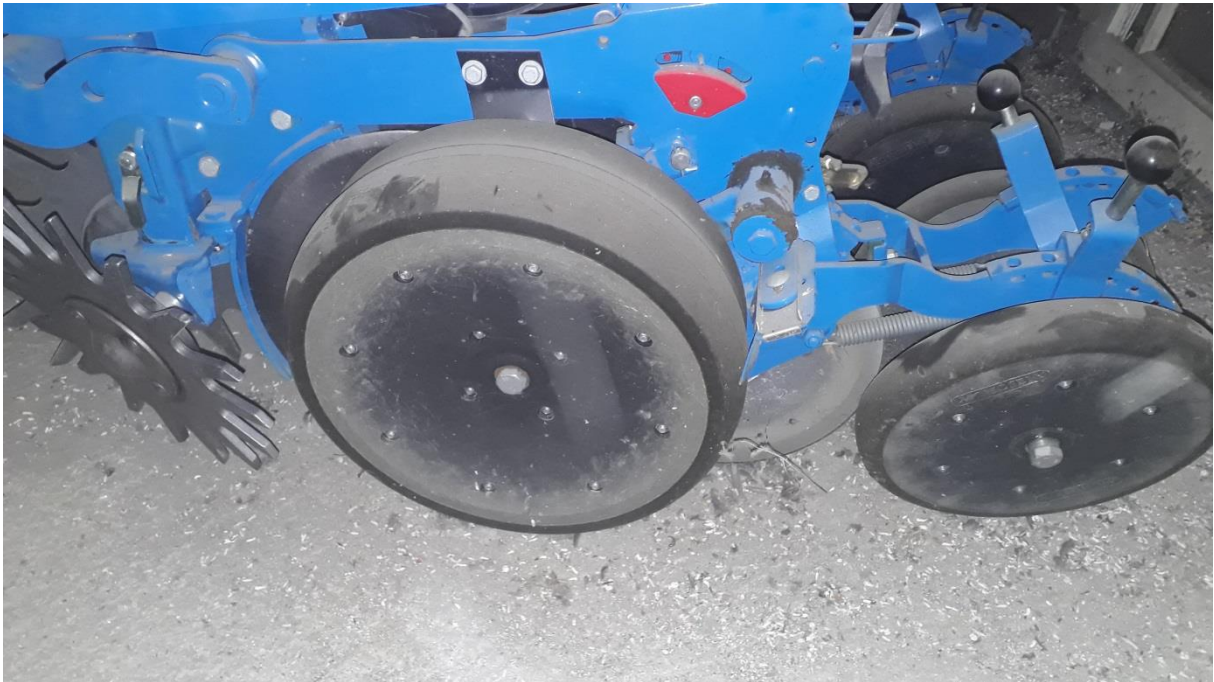
Einzelkorn-Sämaschine mit Sternrad-Klutenräumer, Scheibenschar, Tiefenführungsrolle, Zwischendruckrolle, Andruckrolle (nicht im Bild: vorlaufende Sechsscheibe)
