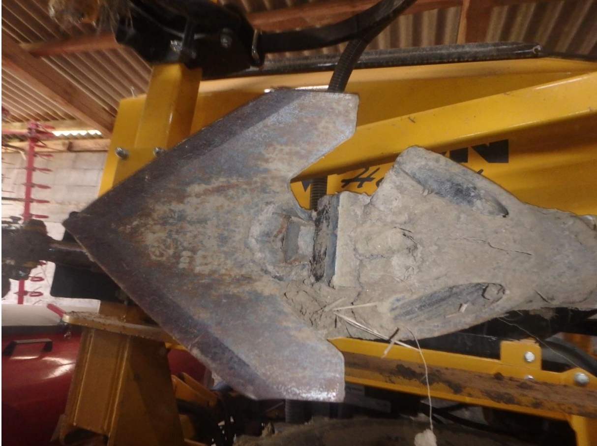
Gänsefußschare und Ablage des Saatguts links und rechts des Lockerungsschlitzes
