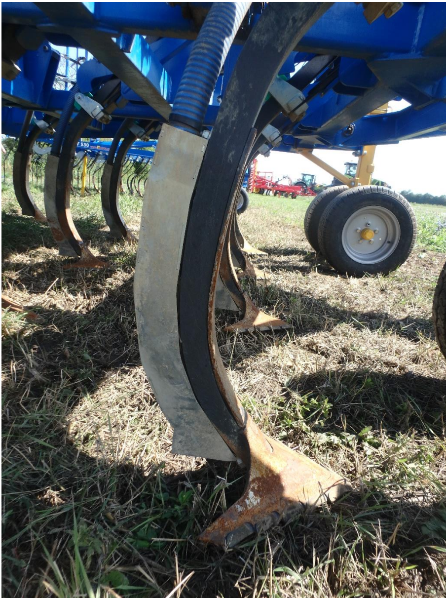
Saatgutablage im Schatten des Gänsefußschares auf den Bearbeitungshorizont
