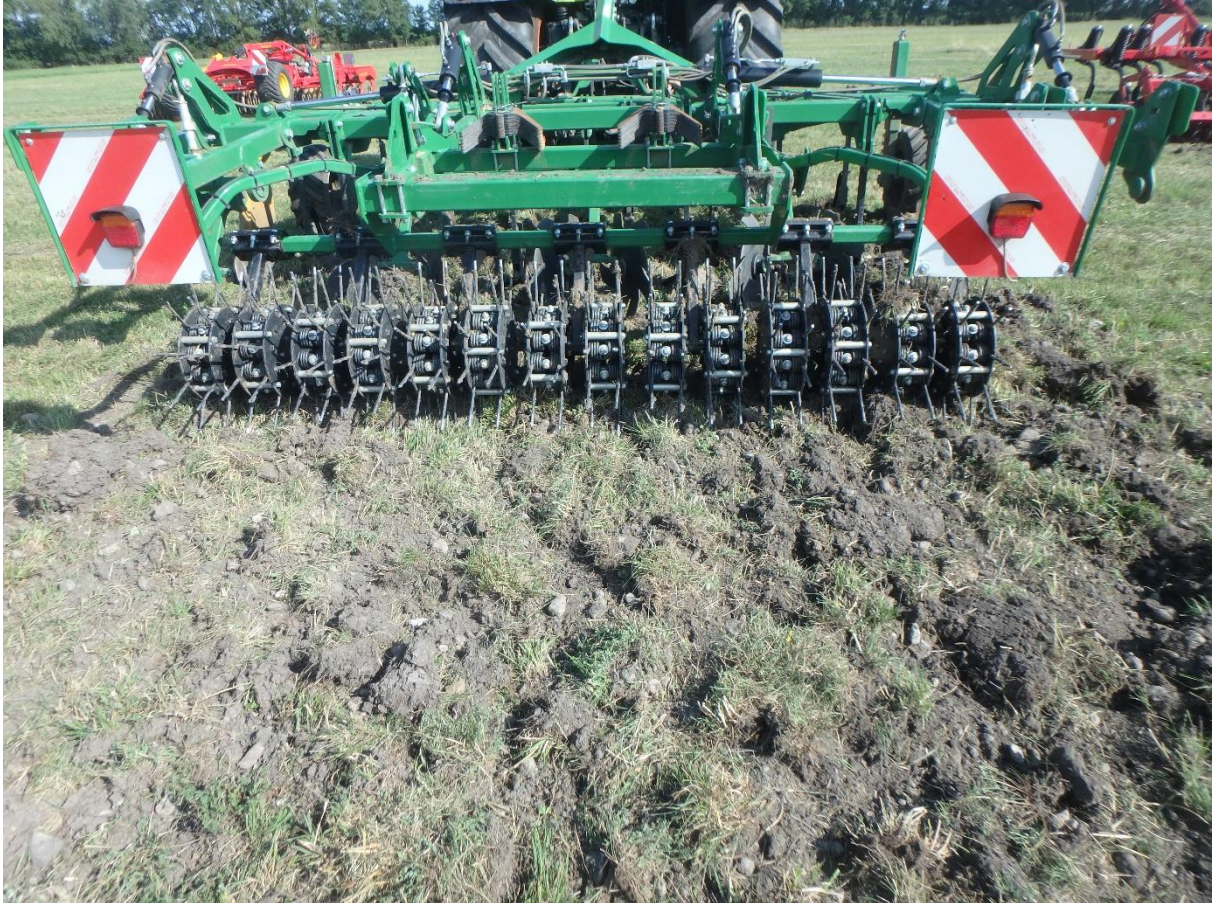
Arbeitsbild des Grubbers Kerner Corona C 450 mit Stachelwalze
