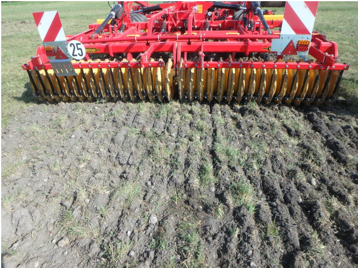
Arbeitsbild des Kombinationsgerätes Väderstad Top down TD 400
