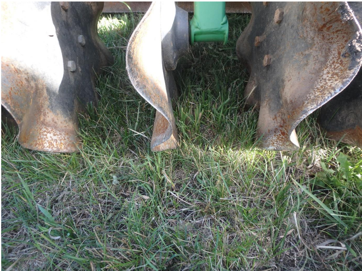
Flache Schlitzte der Wellscheiben
