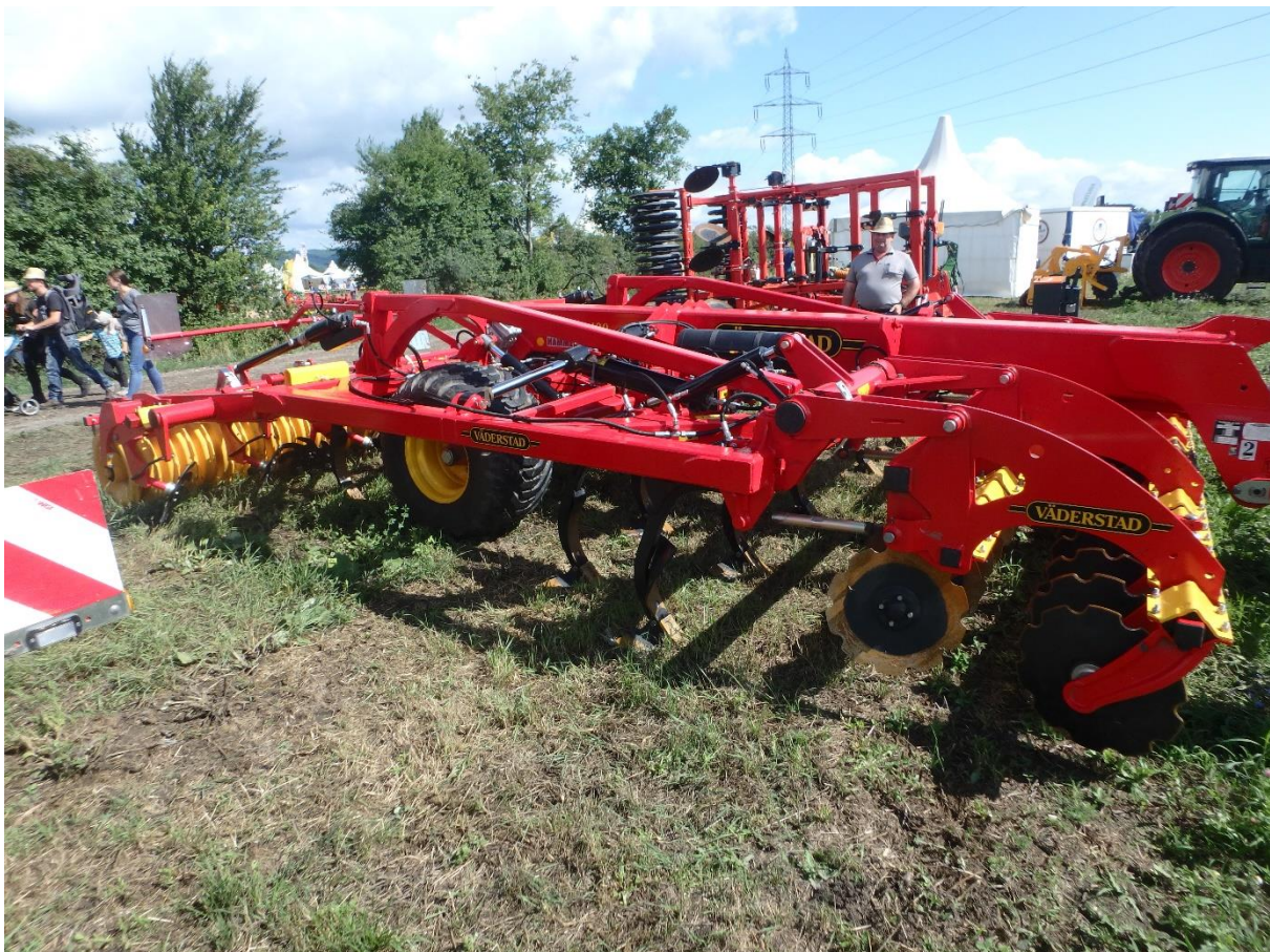
Kombinationsgerät Väderstad Top down TD 400
