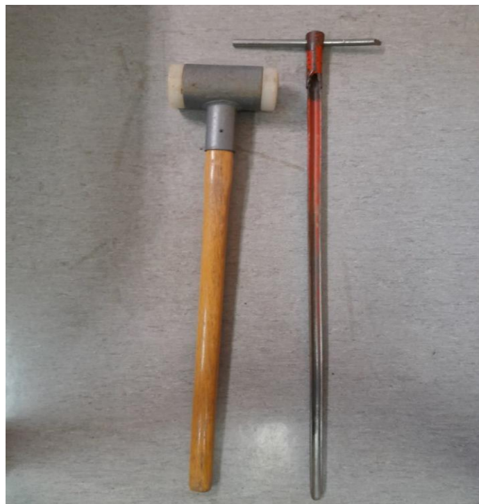
Bodenbohrer zur händischen Entnahme von Bodenproben bis 90cm Tiefe
