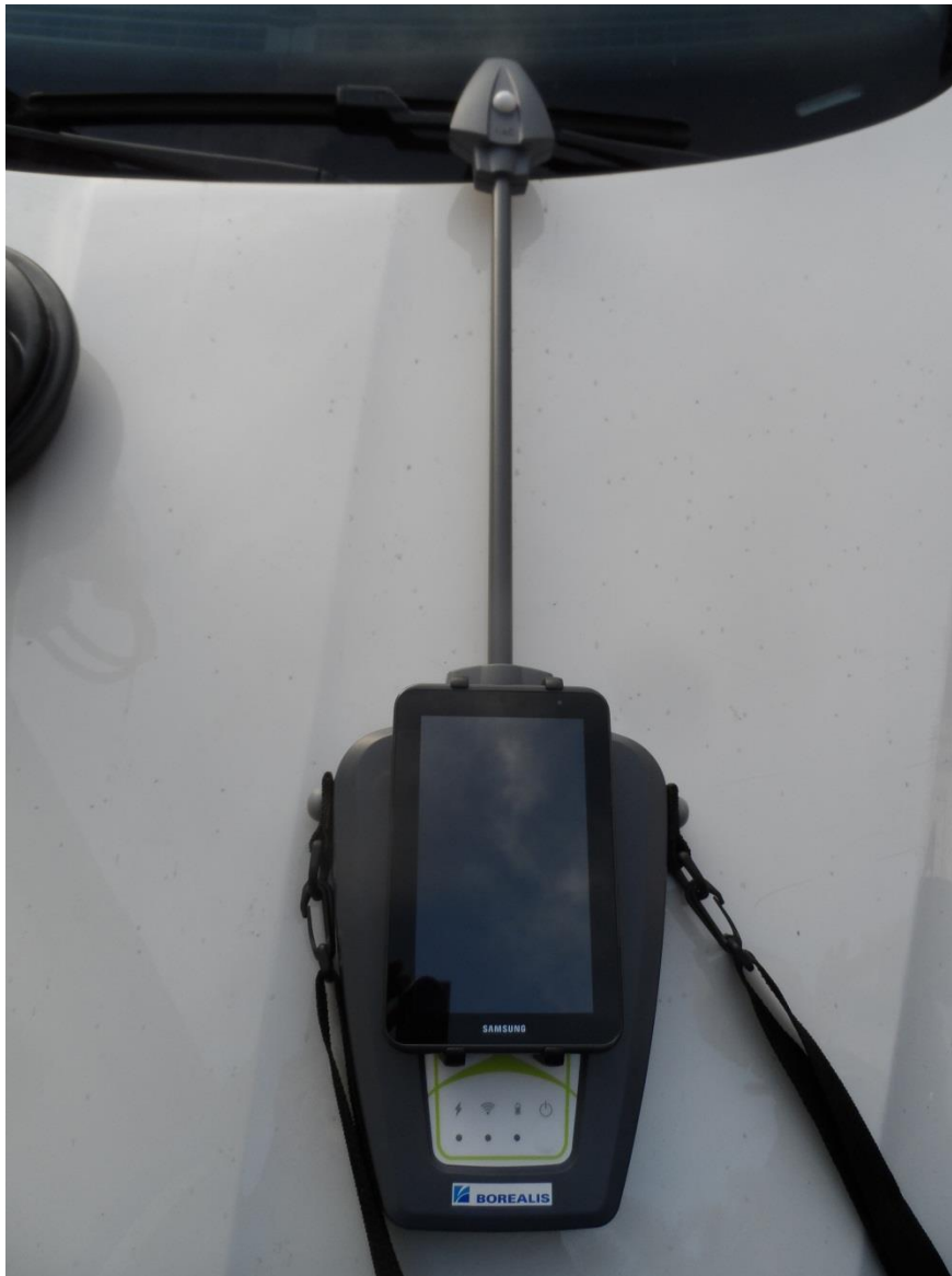
Abb.2: Der N-Pilot misst Globalstrahlung, Biomasse und die Grünfärbung der Kulturen
