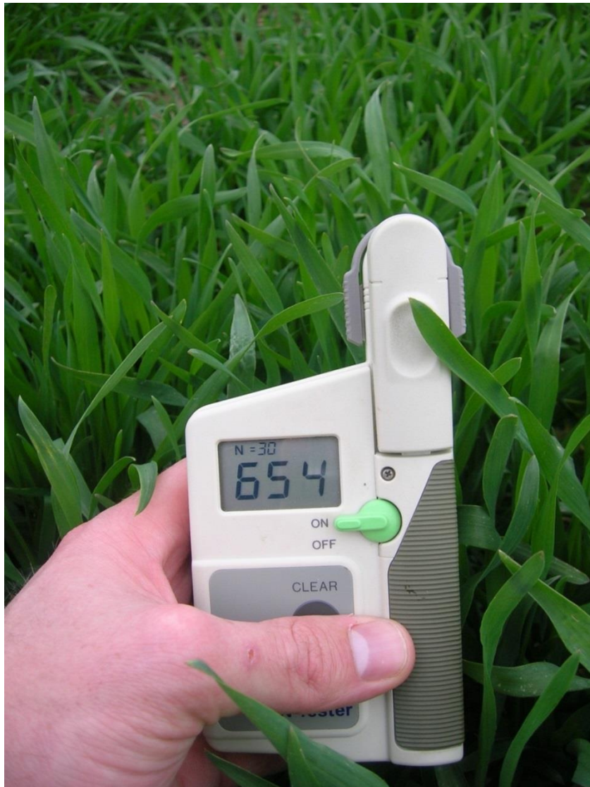
Abb. 1 Der N-Tester misst die Blattfarbe der Getreidepflanzen
